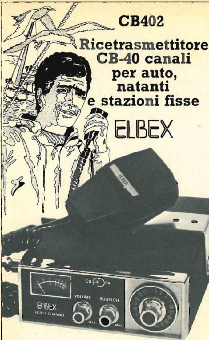
Il "CB402" è un ricetrasmittitore operante sulla banda cittadina (CB) in AM - 27 MHz. Utilizza un circuito sintetizzatore di frequenza in PLL per generare con precisione la frequenza dei 40 canali. Funziona sia su mezzi veicolari, sia in stazione fissa con alimentatore esterno a 13,8 Vc.c. stabilizzati.
