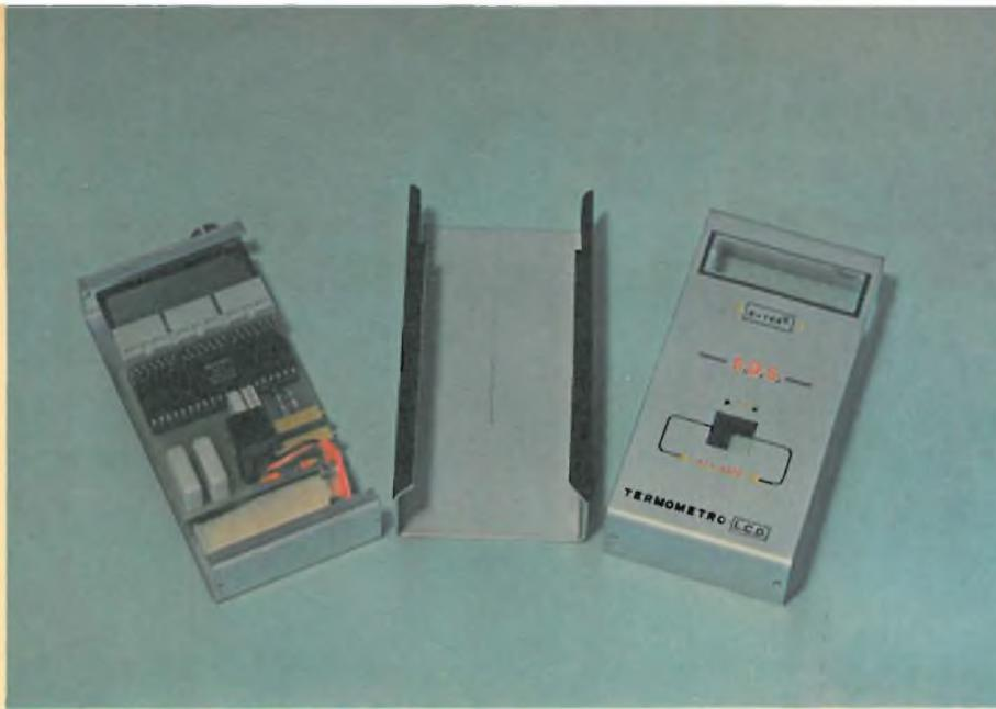
Termometro digitale a cristalli liquidi a realizzazione ultimata prima dell'assemblaggio.
