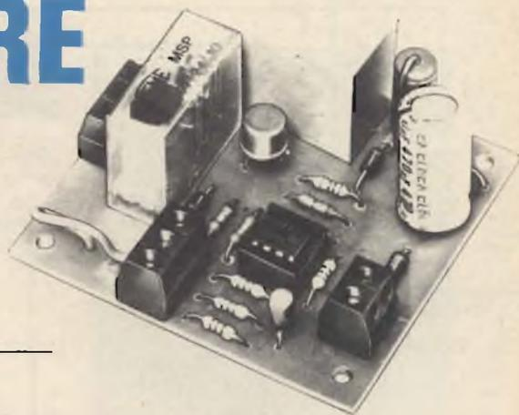
**Gli ingombranti e fragili meccanismi ad orologeria elettromeccanici che stabiliscono il tempo di accensione della luce-scale, possono (anzi dovrebbero!) essere sostituiti con questo timer elettronico a basso consumo, alta precisione, ottima affidabilità. Tra l'altro, il dispositivo è anche notevolmente economico, se paragonato ai vecchi congegni "che fanno tic-tac".**
