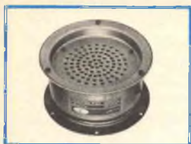
SIRENA ELETTRONICA "AMTRON" Mod. UK 11W Protezione contro l'inversione di polarità Resa acustica: 12 Vc.c. Assorbimento medio: 500 mA Alimentazione: 12 Vc.c. Dimensioni: Ø 131x65 SM/1011-07
