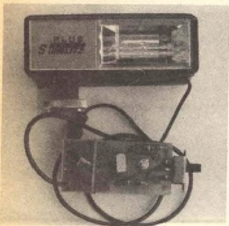
Fig. 16 - Il sincronizzatore in azione con un flash elettronico.
