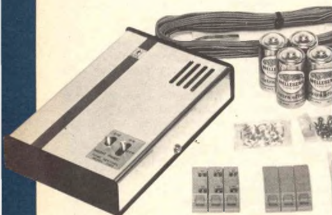
SIRENA ELETTRONICA BITONALE AUTOPROTETTA "SPACE ALARM" Mod. SEA 1 Resa: 118 phn Possibilità di contenere una batteria da 1,8 A/h. Ricarica in tampone della batteria Collegamento alla centralina con protezione al taglio dei fili, alla caduta di tensione, ed al cortocircuito. Doppio circuito di guardia. Assorbimento: 1,8 A/h Dimensioni: 190x155x80 mm OT/7810-00
