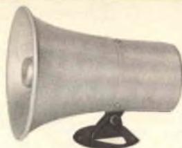
SIRENA ELETTRONICA BITONALE Livello di uscita a 1 m: 110 dB Frequenza: 800 ± 1.200 kHz Potenza: 6 W Alimentazione: 12 Vc.c. Dimensioni: Ø 130 x 165 mm OT/7630-00
