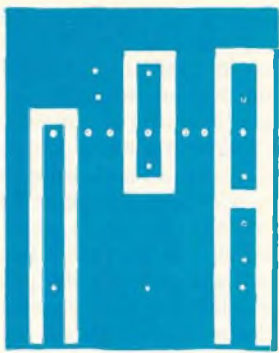
Fig. 11 - Basetta a circuito stampato adatta ad amplificatori a 7 terminali.
