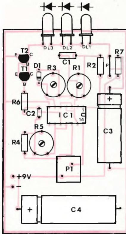
Fig. 4 - Disposizione dei componenti sulla basetta di figura 3
