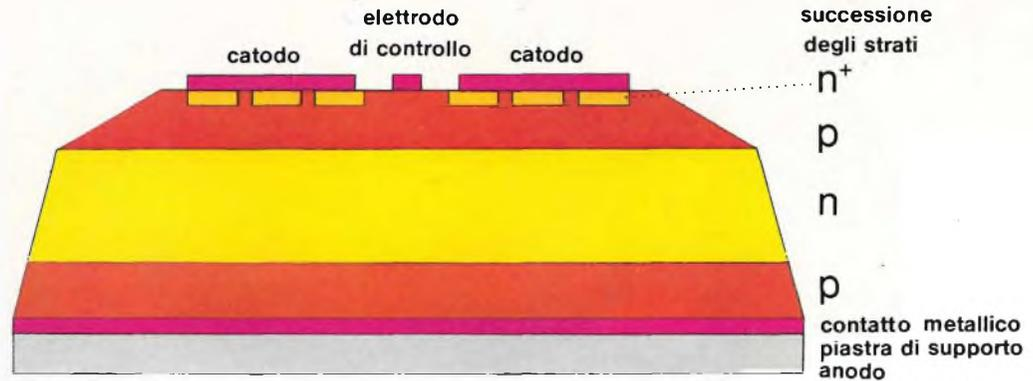
8 Tiristore finito (rappresentazione schematica della sezione verticale).
