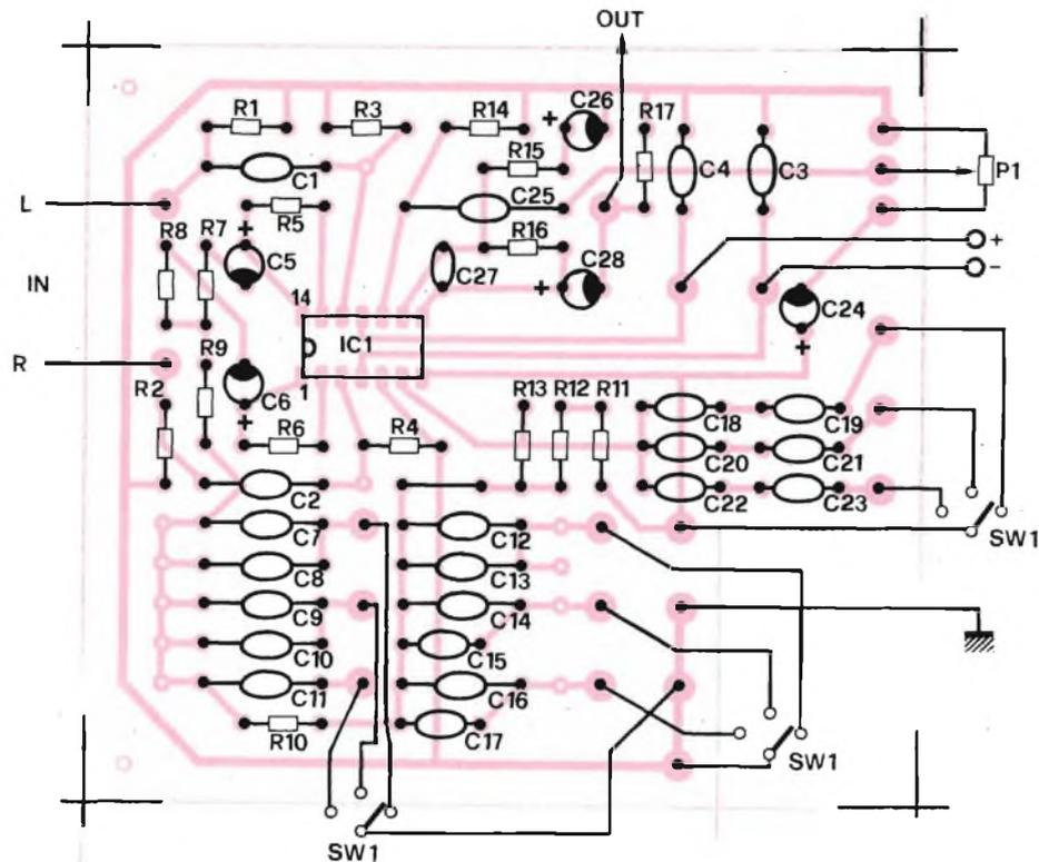
Fig. 5 - Lato componenti della basetta filtro passa-basso.
