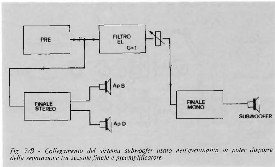
Fig. 7/B - Collegamento del sistema subwoofer usato nell'eventualità di poter disporre della separazione tra sezione finale e preamplificatore.
