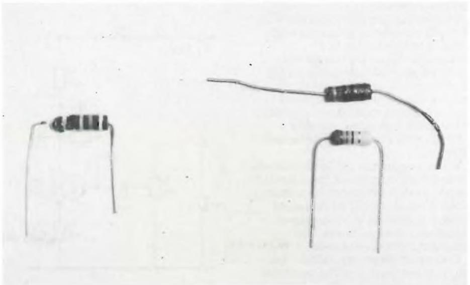
*Fig. 1 - Resistenze surriscaldate da una eccessiva dissipazione. Le fascette distintive, in queste condizioni mutano colore, così come l'elemento interno a carbone cambia la resistenza intrinseca, sicché è difficilissimo stabilire il valore originale.*
