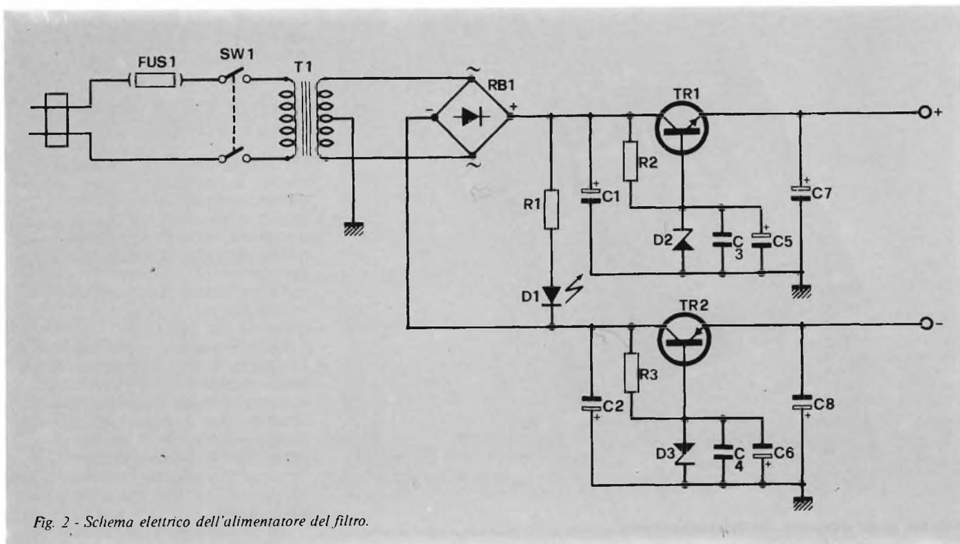
Fig. 2 - Schema elettrico dell'alimentatore del filtro.
