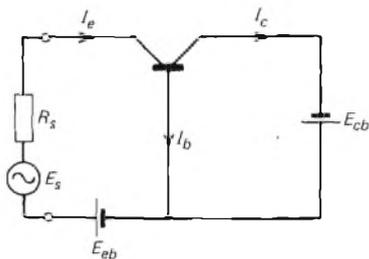
Fig. 3.4 - Connessione tip a base comune.
