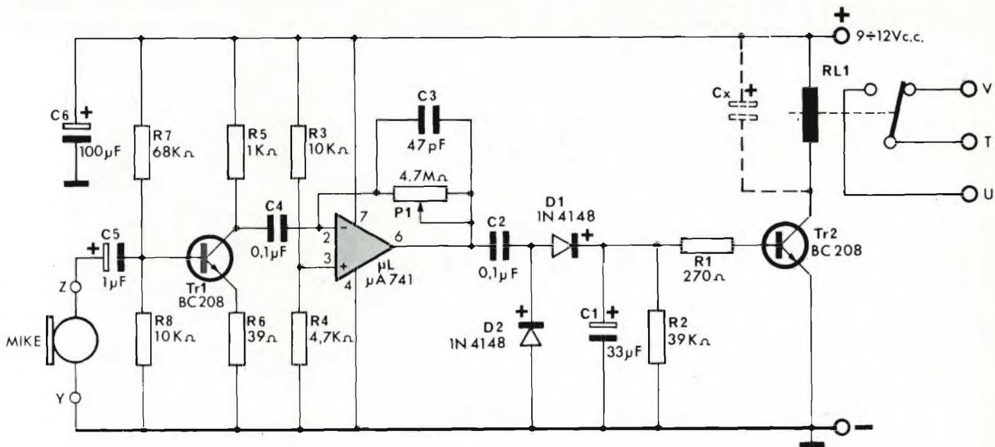
Fig. 1 - Schema elettrico del KS 470 della Kuriuskit.
