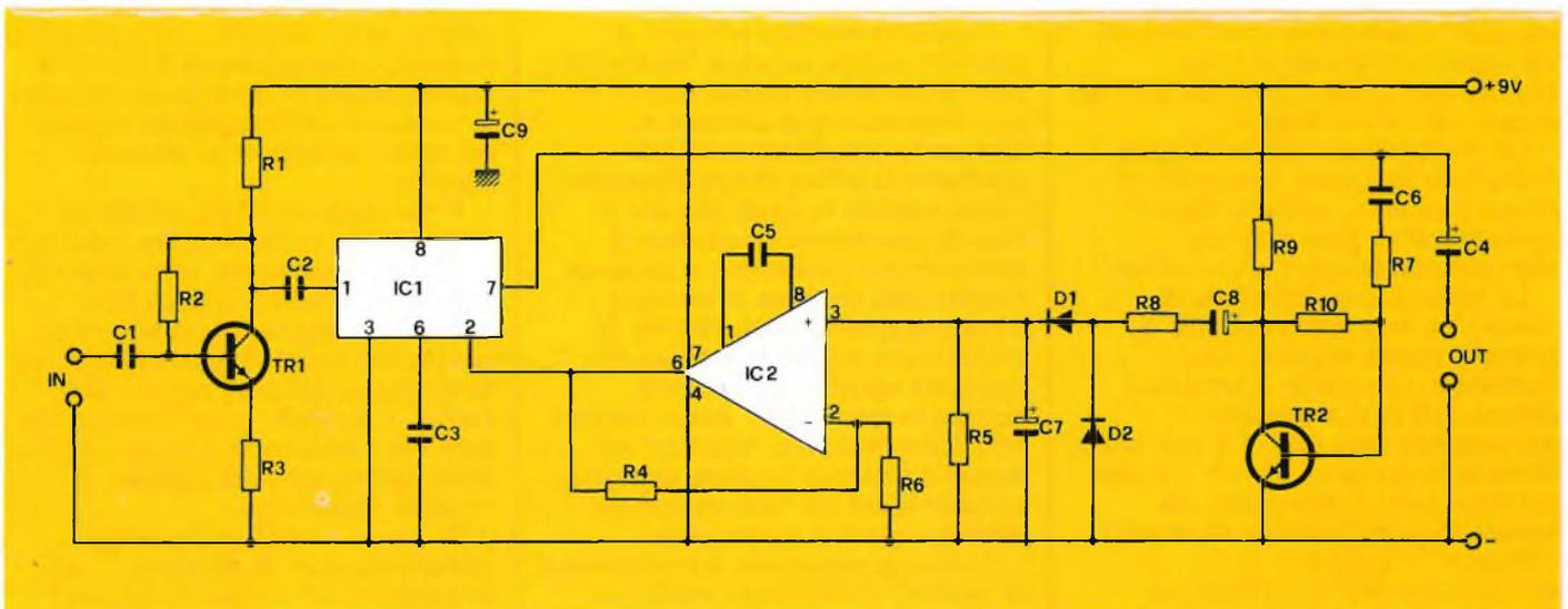
Fig. 2 - Schema elettrico completo del pedale di "Sustain".
