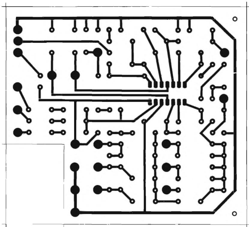
Fig. 3 - Basetta master lato rame della sezione filtro.
