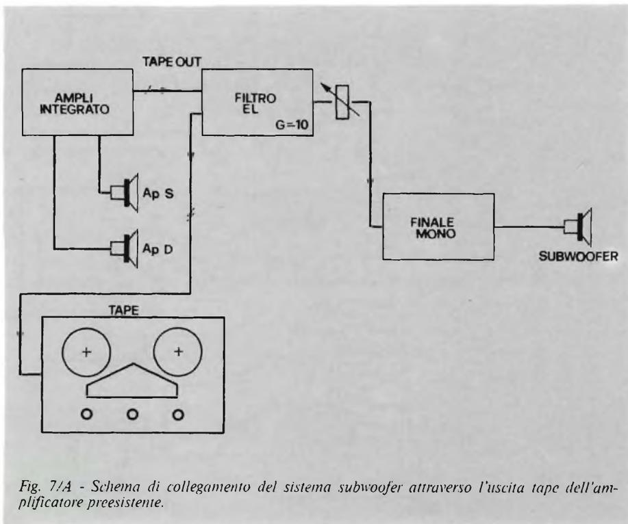
Fig. 7/A - Schema di collegamento del sistema subwoofer attraverso l'uscita tape dell'amplificatore preesistente.
