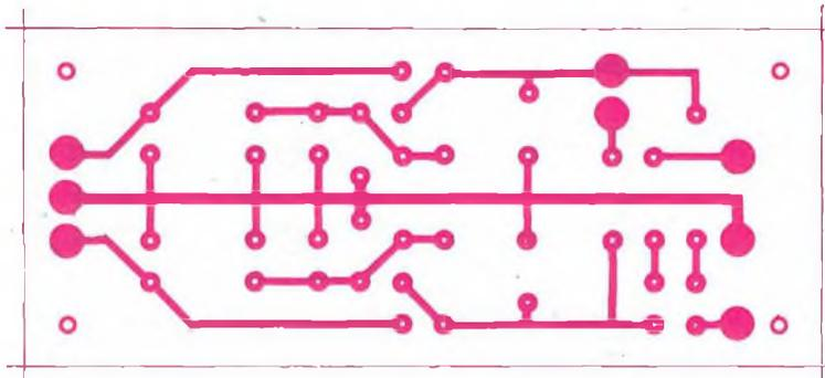
Fig. 4 - Circuito stampato in scala 1:1 dell'alimentatore.
