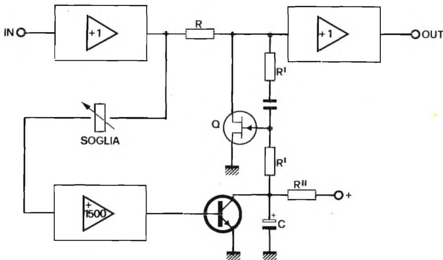
Fig. 3 - Diagramma funzionale del circuito di "noise gate".
