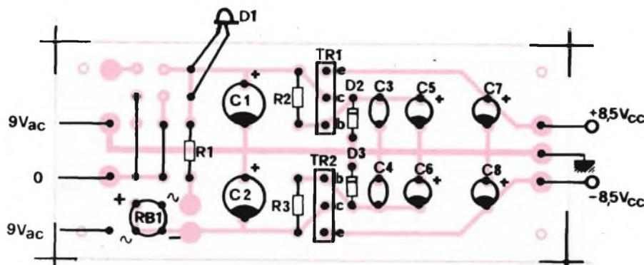
Fig. 6 - Vista del circuito stampato lato componenti dell'alimentatore.
