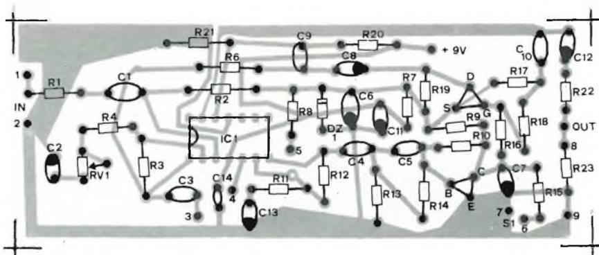
Fig. 6 - Disposizione dei componenti sulla basetta di figura 5.
