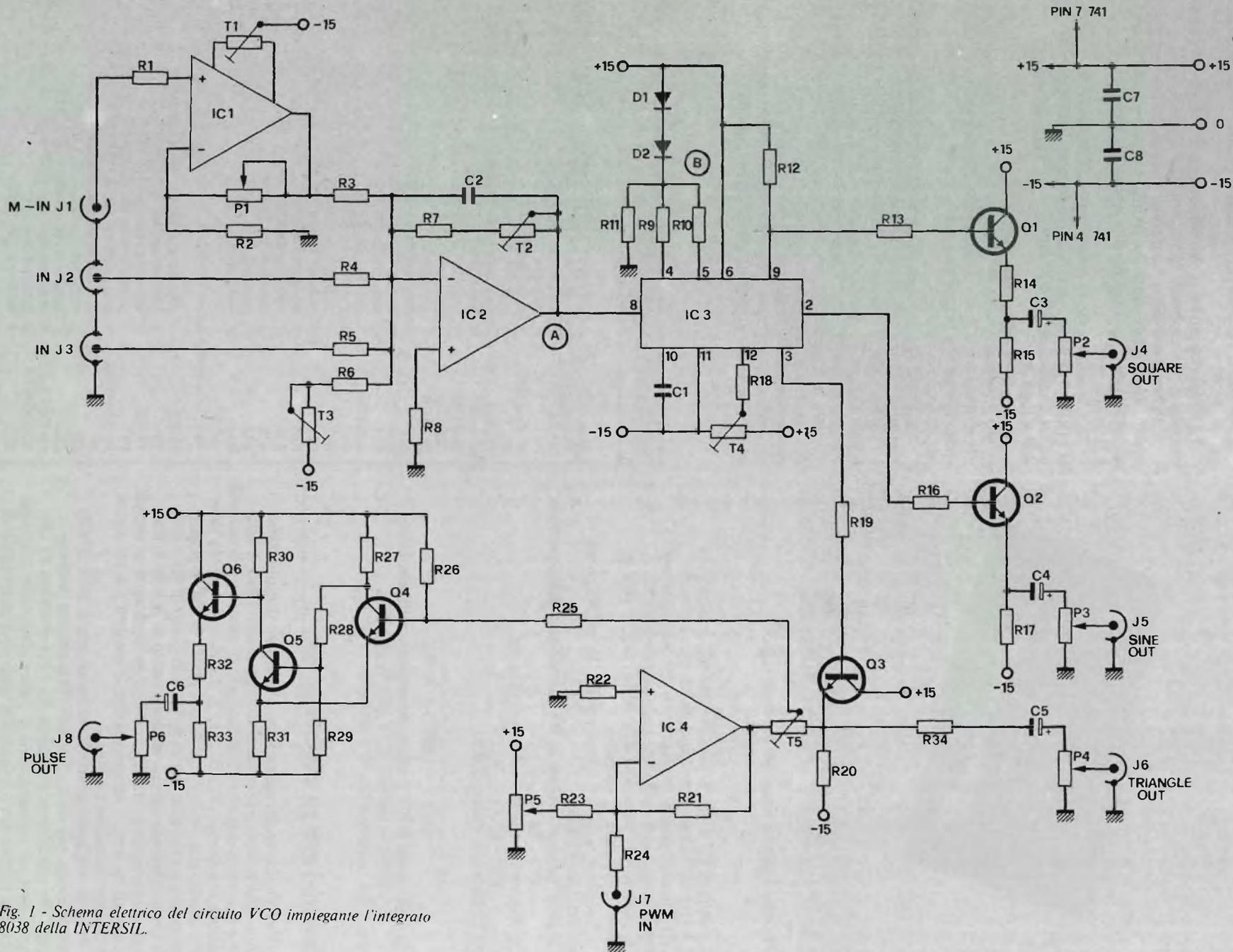
Fig. 1 - Schema elettrico del circuito VCO impiegante l'integrato 8038 della INTERSIL.
