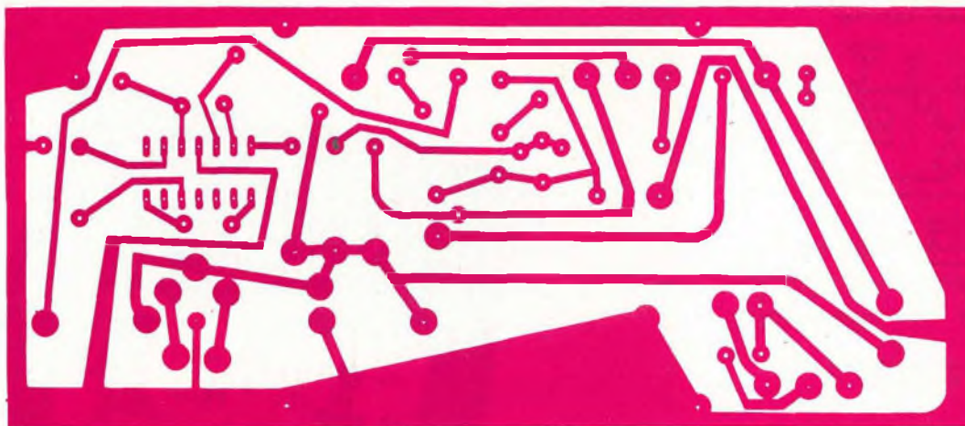
Fig. 4 - Basetta vista dal lato rame in scala 1:1.
