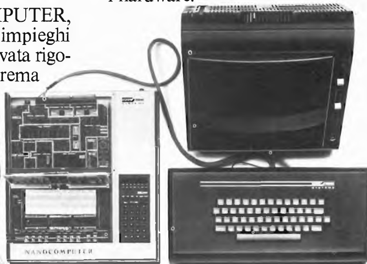
NBZ80-HL. Con 16K byte di RAM, tastiera alfanumerica con interfaccia video, 8K ROM di Basic su scheda addizionale, libro Basic Programming Primer, monitor TV (opzionale).
