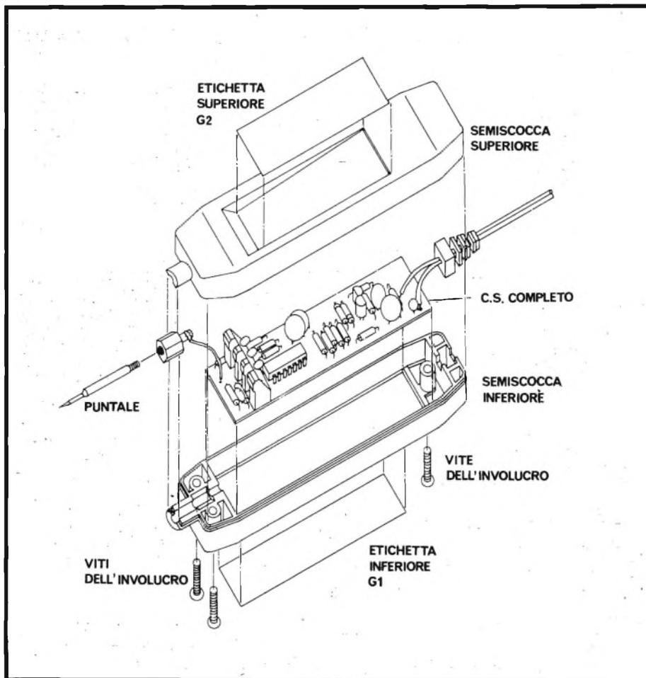
Fig. 8 - Assemblaggio finale.
