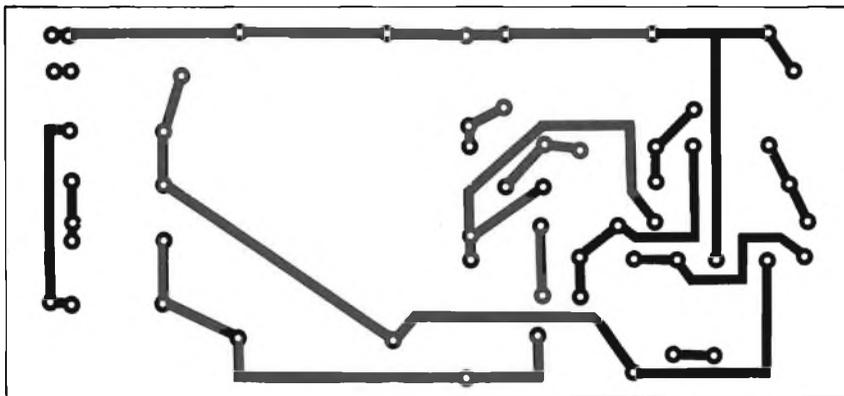
Fig. 12 - Circuito stampato dell'alimentatore lato rame
