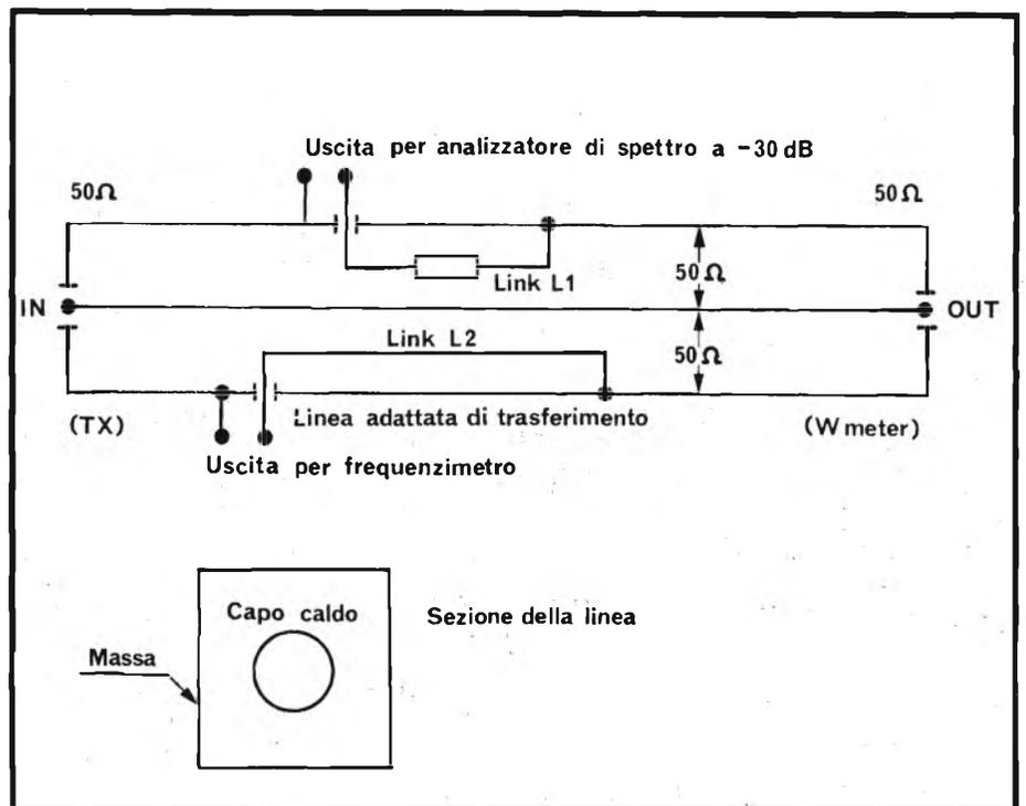
Fig. 2 - Schema delle varie uscite dell'accoppiatore.
