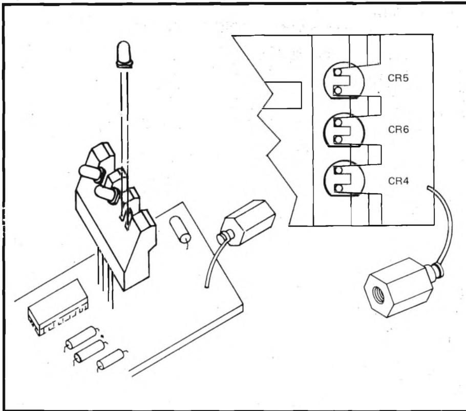
Fig. 7 - Inserimento dei Led nel relativo supporto.
