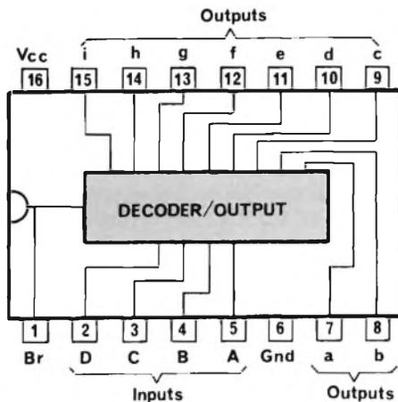
Fig. 3 - Zoccolatura dell'integrato decodificatore 4 bit 7 segmenti.
