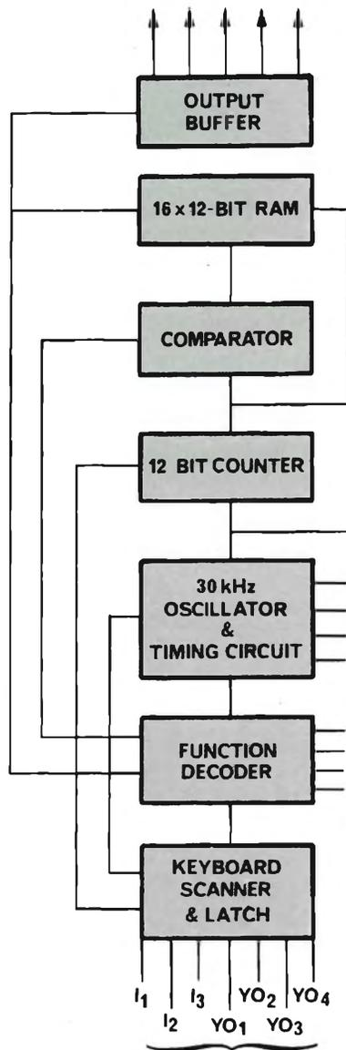
Fig. 2 - Schema a blocchi interno dell'integrato SAA 1089.
