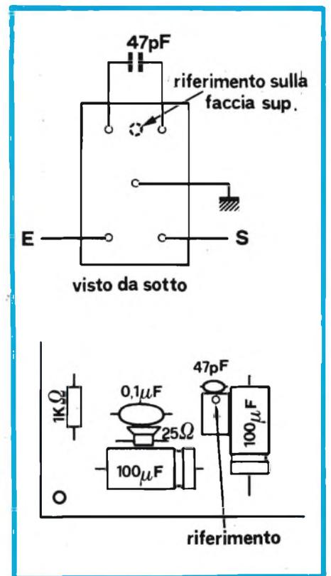
Fig. 4/a - Cablaggio del filtro ceramico 455 kHz, tipo SFZ 455 color giallo
