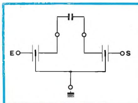
Fig. 4 - Schema interno d'un filtro ceramico SFD 445
