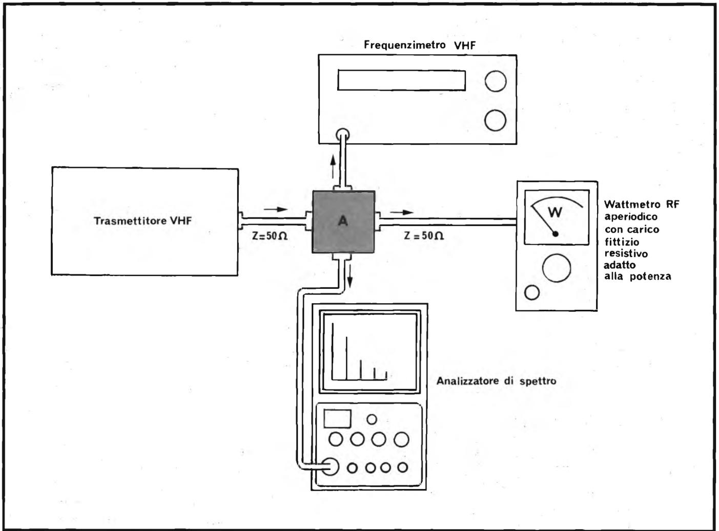
Fig. 1 - Connessioni dell'accoppiatore a 50 Ω ai diversi strumenti di laboratorio.
