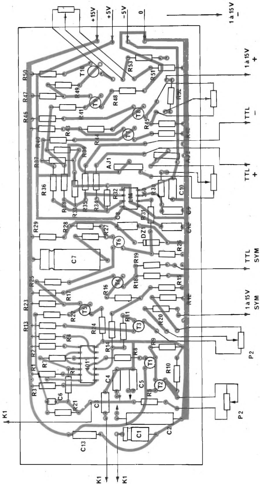
Fig. 11 - Circuito stampato del generatore lato componenti
