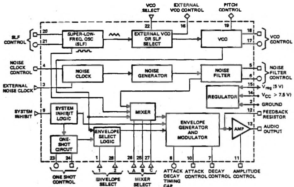
Fig. 1 - Circuito a blocchi dell'IC "SN76477".
