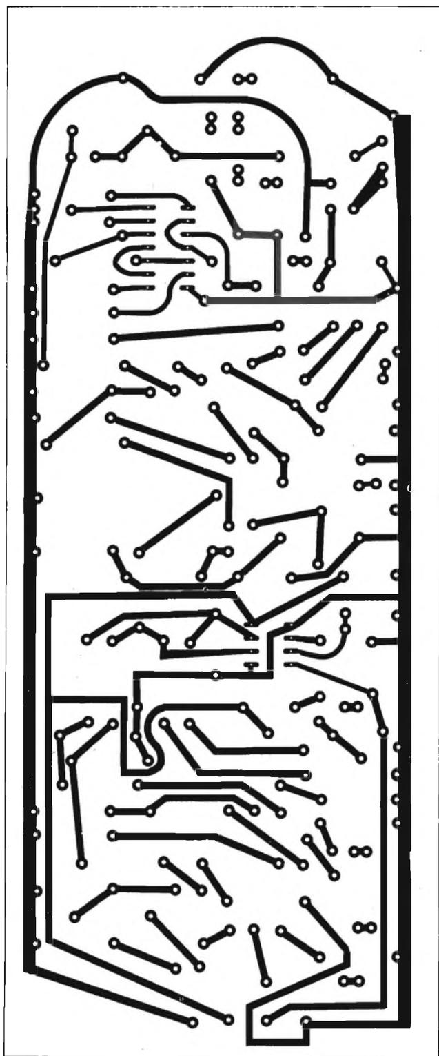
Fig. 10 - Circuito stampato del generatore d'impulsi lato rame
