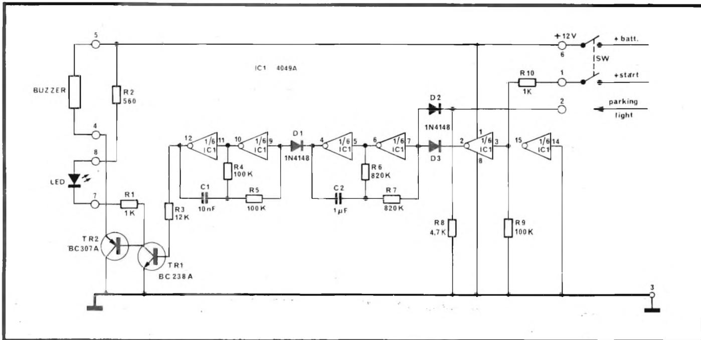
Fig. 1 - Schema elettrico dell'avvisatore di luci accese KS 452 della Kuruskit.
