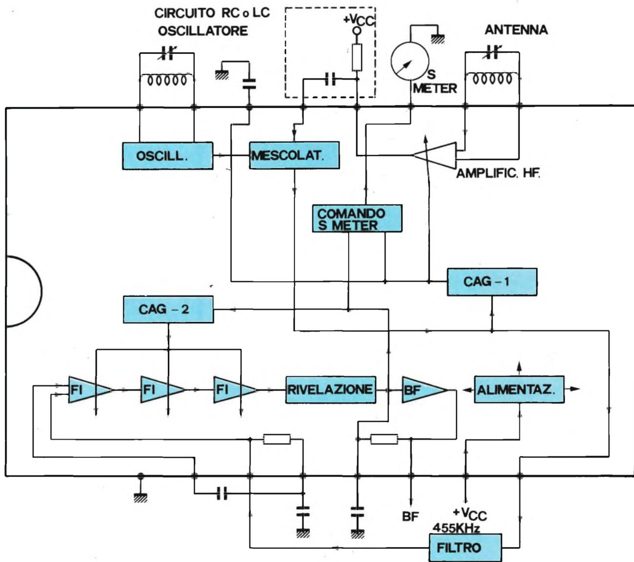
Fig. 2 - Circuito interno a blocchi del TDA 1046
