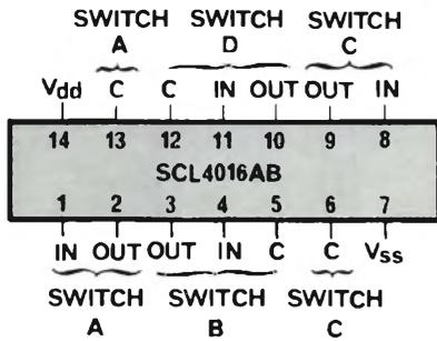
Fig. 7 - Zoccolatura dell'interruttore elettronico MC 14016
