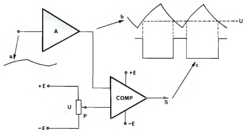
Fig. 6 - Elaboratore di un segnale esponenziale per ottenere cerniere a rapporto ciclico variabile
