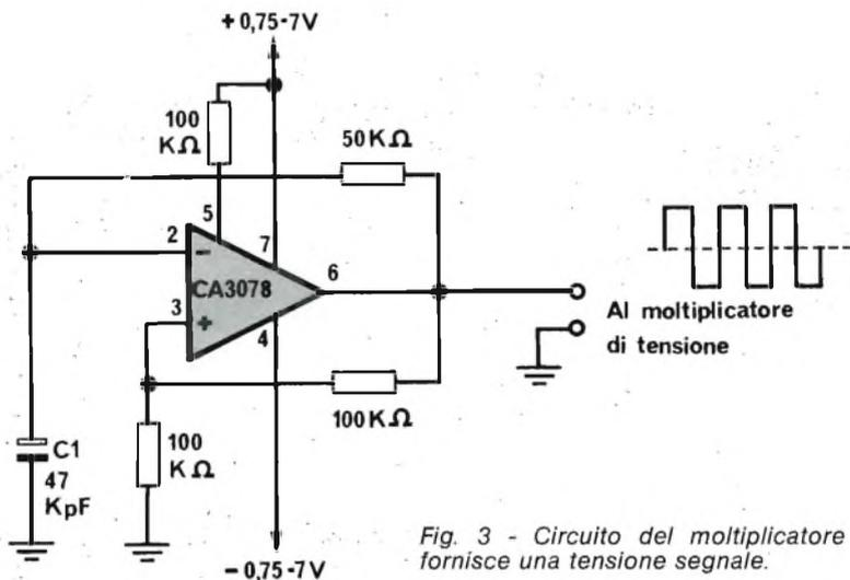
Fig. 3 - Circuito del moltiplicatore che fornisce una tensione segnale.
