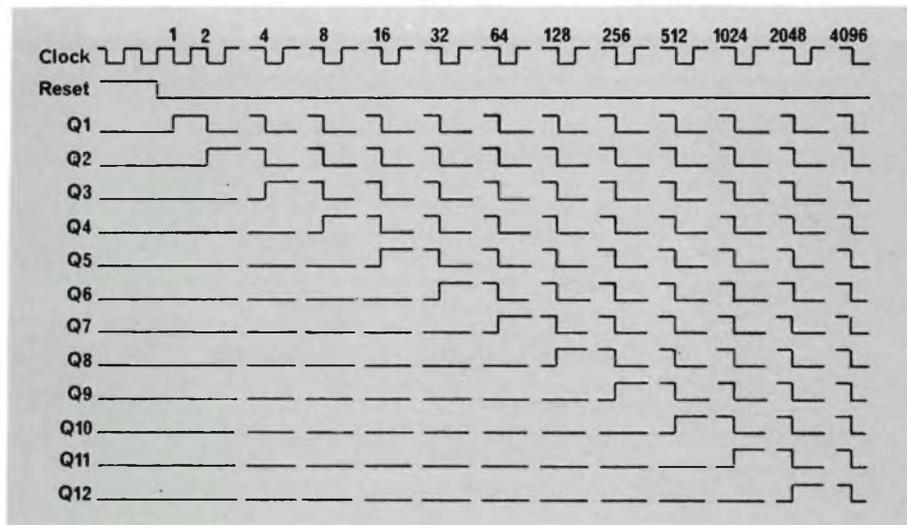
Fig. 5 - Diagramma dei tempi dell'integrato MC 14040.
