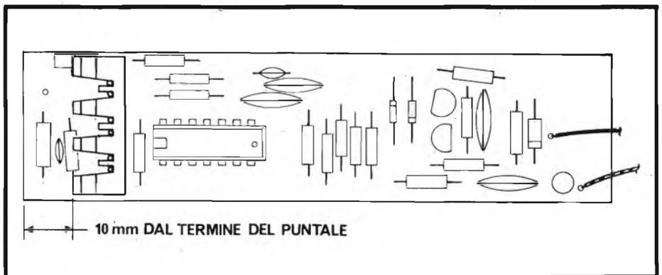
Fig. 6 - Basetta a circuito stampato vista in piana. si noti dove inserire il supporto dei led.
