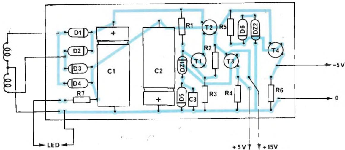
Fig. 13 - Circuito stampato dell'alimentatore lato componenti
