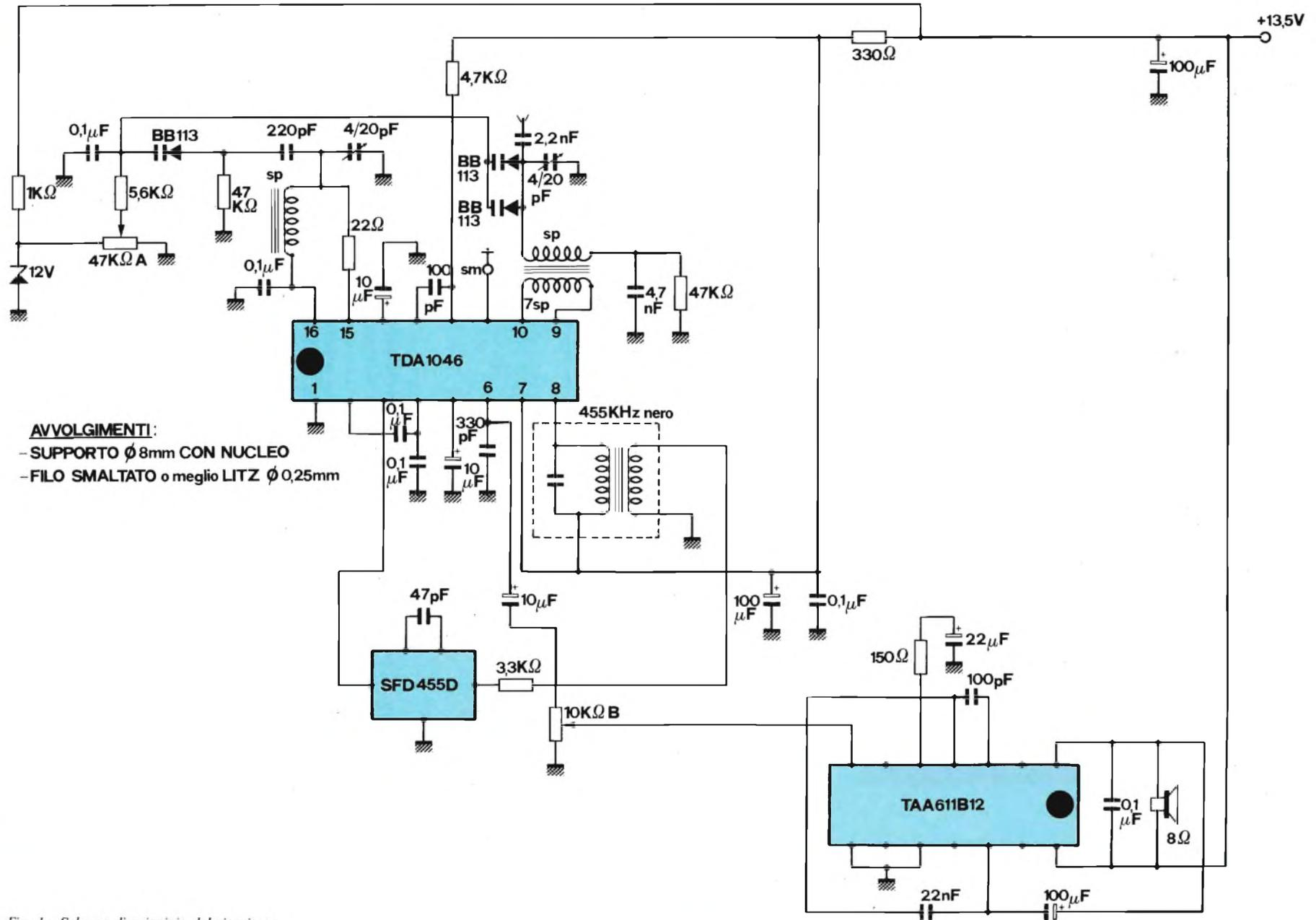
Fig. 1 - Schema di principio del ricevitore
