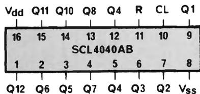
Fig. 4 - Piedinatura del contatore a 12 bit - SCL4040AB.
