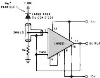
Fig. 5 - Schema elettrico di un rivelatore di radiazioni.
