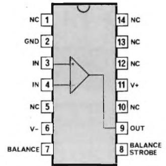
Fig. 8 - Piedinatura del comparatore di tensione LM 211
