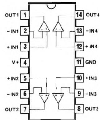
Fig. 6 - Disposizione dei piedini del quadruplo operazionale LM 324.
