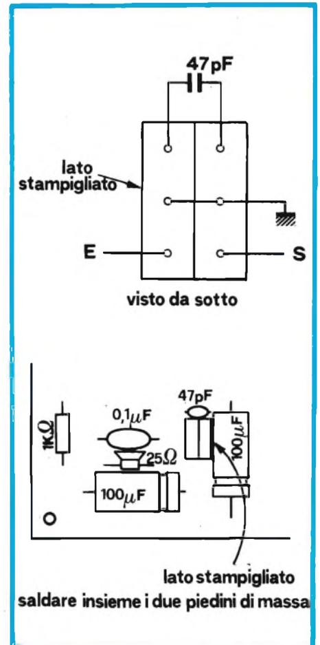
Fig. 4/b - Cablaggio del filtro economico 455 kHz, tipo SFD 455 D colore rosso
