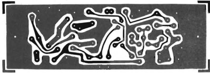
Fig. 3 - Circuito stampato (lato rame) dell'amplificatore di figura 3. Scala 1:1.
