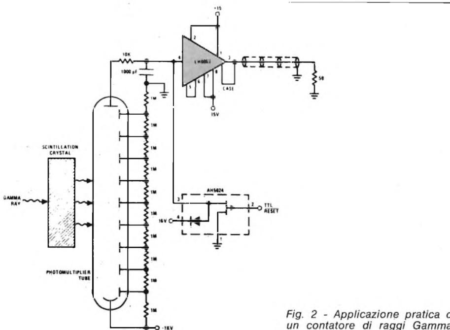
Fig. 2 - Applicazione pratica di un contatore di raggi Gamma.
