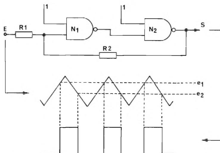
Fig. 3 - Esempi di oscillatore di Schmitt
