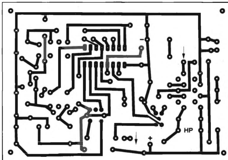
Fig. 6 - circuito stampato lato rame in scala 1 : 1
