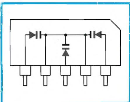
Fig. 3 - Zoccolatura del triplo varicap BB113
