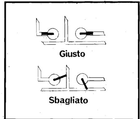
Fig. 3 - Giusto sistema di piegatura e saldatura.
