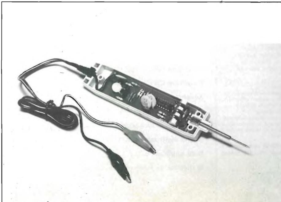
elettrico di fig. 1). Il comparatore a finestra, ha una polarizzazione stabilisce i livelli logici "1" e "0". Questi livelli sono determinati in base all'alimentazione che proviene dal circuito in prova. La logica "1" corrisponde al 70% della Vcc, la logica "0" al 30% della Vcc.
