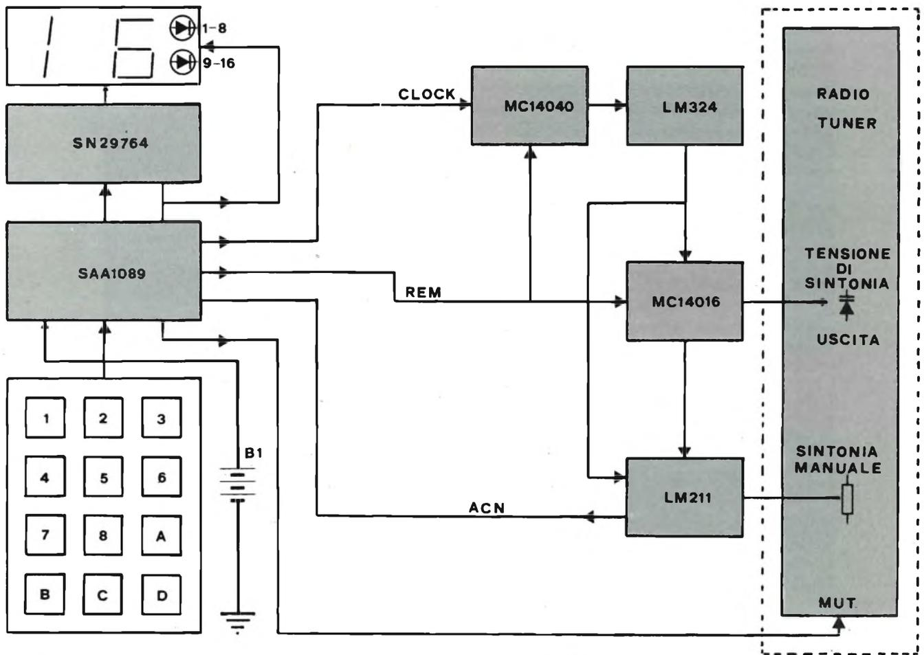
Fig. 1 - Schema a blocchi completo della sintonia computerizzata
