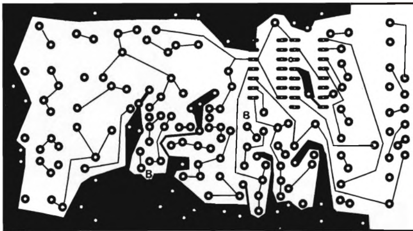
Fig. 1 - Circuito stampato, lato rame, scala 1 : 1. I punti B-B vanno collegati tra di loro.
