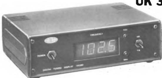
Sistema di verifica precisa della frequenza alla quale è sintonizzato un radioricevitore oppure un sintonizzatore sia in AM che in FM. La lettura della frequenza di ricezione è visualizzata su un display numerico di grandi dimensioni.
