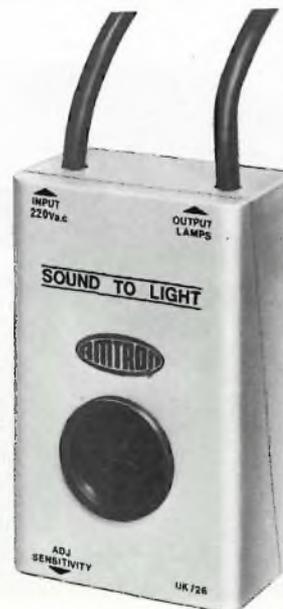
Sistema per la modulazione della luce a mezzo di microfono. Pratico per la realizzazione estemporanea di giochi di luce psichedelici, senza bisogno di complesse installazioni. Circuito estremamente efficiente e di elevata sensibilità. Ingombro minimo.
