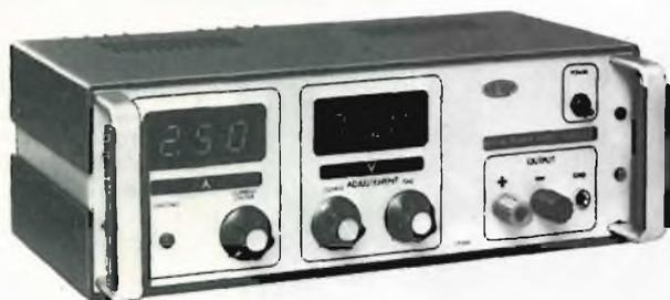
Alimentatore da laboratorio, stabile e maneggevole. Possibilità di regolazione continua della tensione su tutta la gamma da 0 a 30 V. Limitazione efficace della corrente a soglia regolabile da 0 a 2,5 A. Letture digitali dei valori
