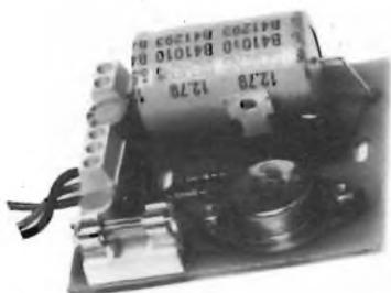
Sezione alimentatrice in versione definitiva. Al posto del regolatore in contenitore TO3 può essere utilizzato quello in contenitore TO220.
