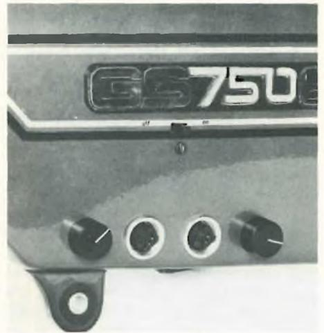
Aspetto esterno dell'interfonico montato sul fianchetto
