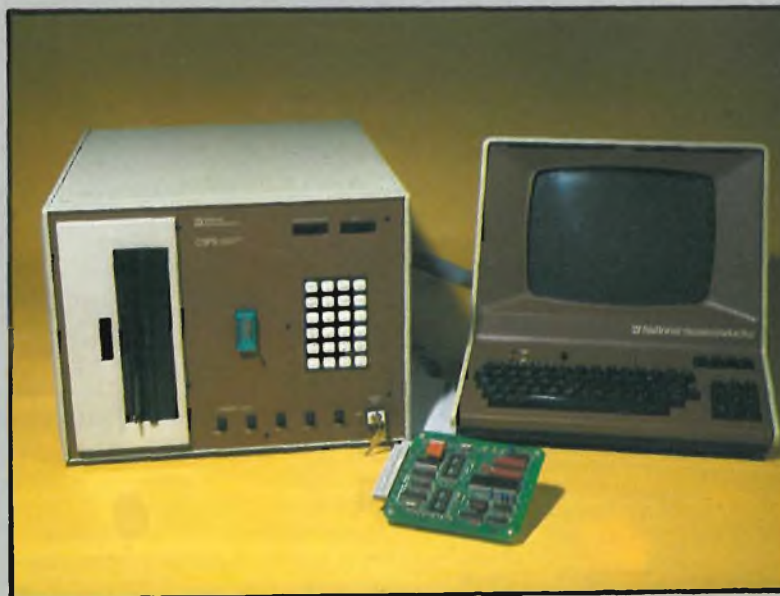
Sistema di sviluppo per i COPS, utilizzato per la realizzazione del software ed il collaudo dell'hardware.
