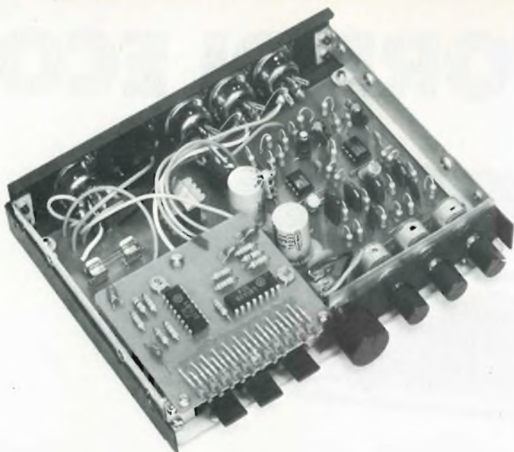
Vista interna del generatore di eco "Bantbridge" mod. KC/5410-00.
