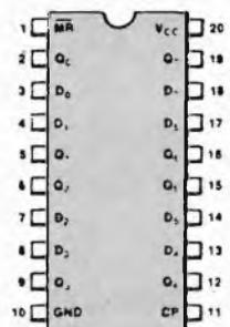
Fig. 10 - Caratteristiche del 74LS273 dal catalogo TTL-LS SGS
