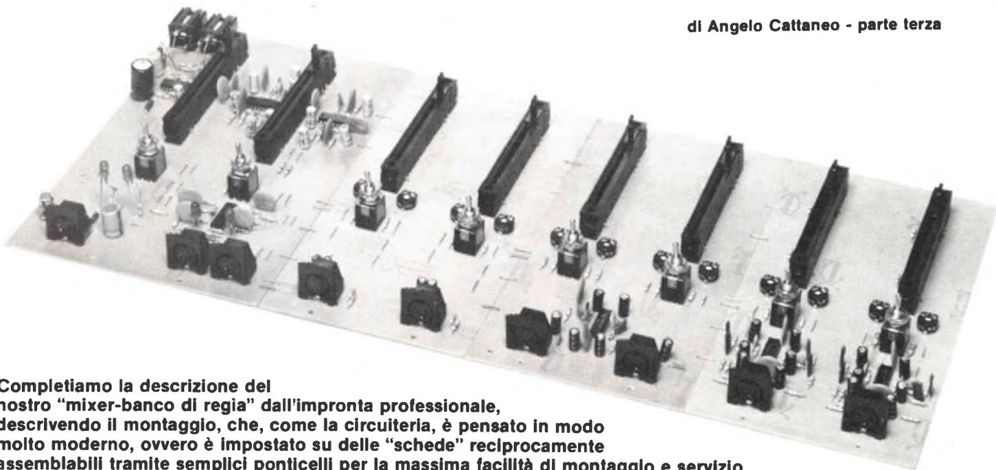
**Completiamo la descrizione del nostro "mixer-banco di regia" dall'impronta professionale, descrivendo il montaggio, che, come la circuiteria, è pensato in modo molto moderno, ovvero è impostato su delle "schede" reciprocamente assemblabili tramite semplici ponticelli per la massima facilità di montaggio e servizio.**
