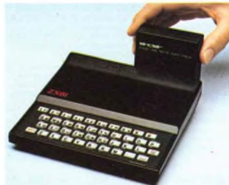
Disegnato per essere collegato ad entrambi i computer ZX 80 e ZX 81, il modulo ZX-RAM si connette con la semplice pressione alla porta di espansione posta sul retro degli apparecchi: la capacità di memorizzare programmi e dati aumenta di ben 16 volte, permettendo di sviluppare programmi piú lunghi e complessi, di realizzare una vera e propria "banca dati" personale e di eseguire piú sofisticati programmi della libreria ZX software.
