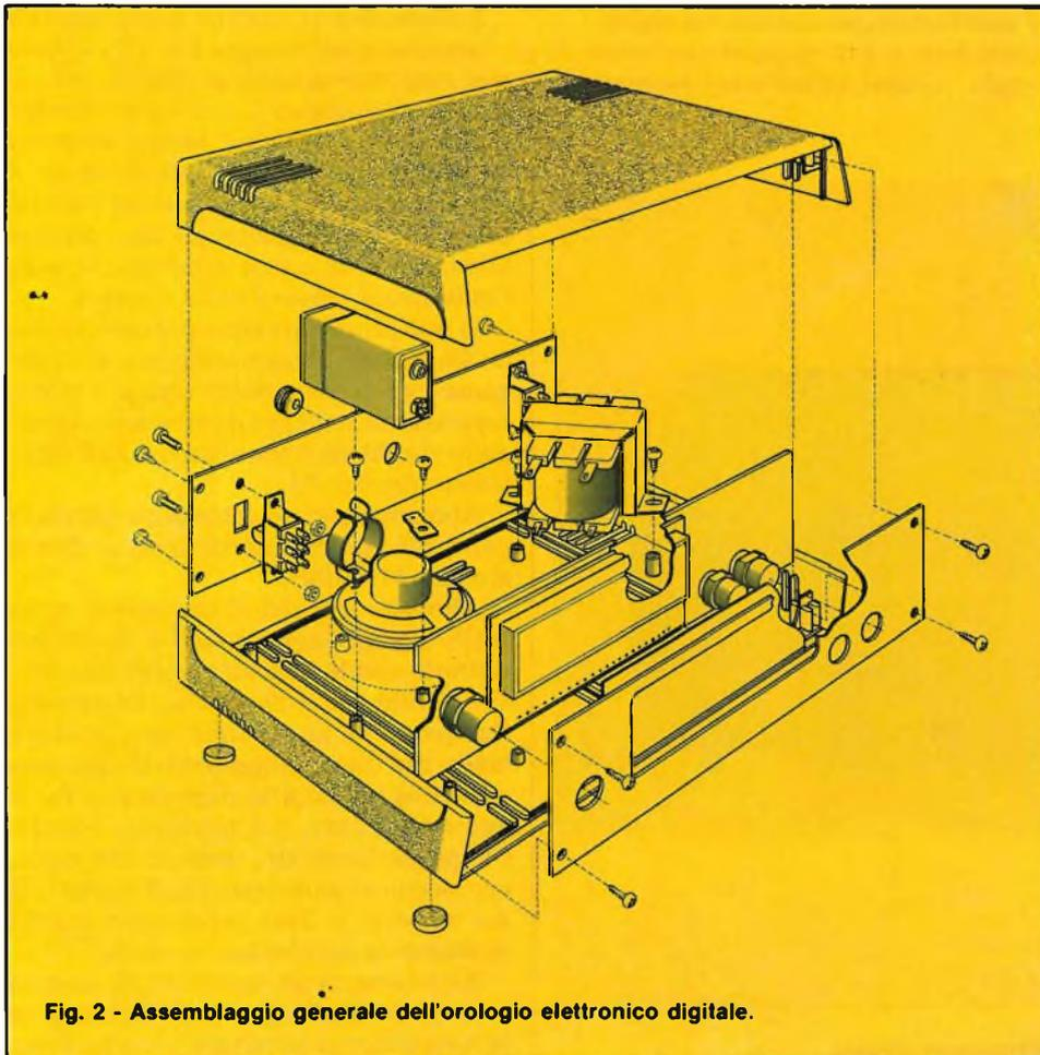
Fig. 2 - Assemblaggio generale dell'orologio elettronico digitale.
