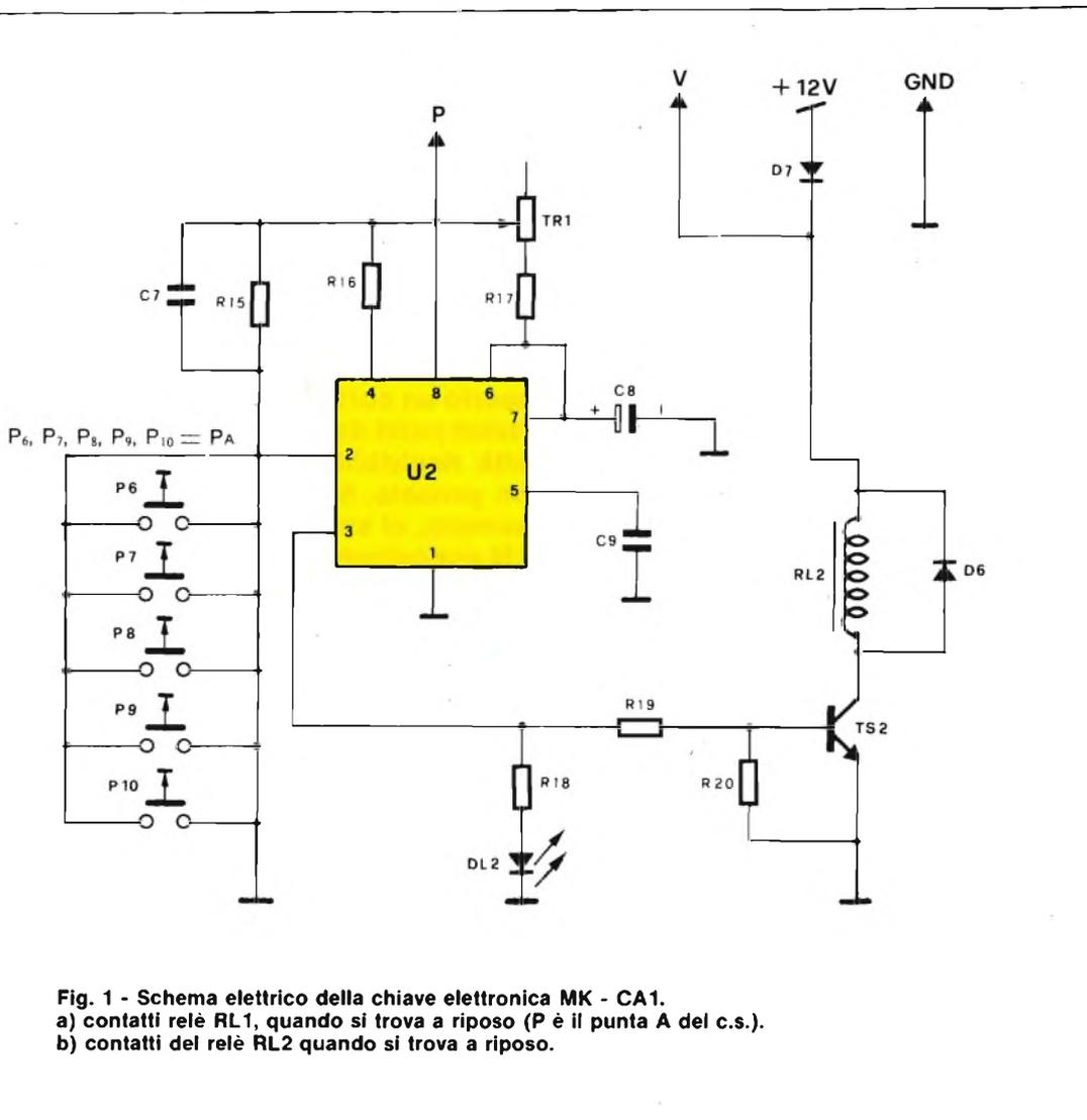
**Fig. 1 - Schema elettrico della chiave elettronica MK - CA1.**
