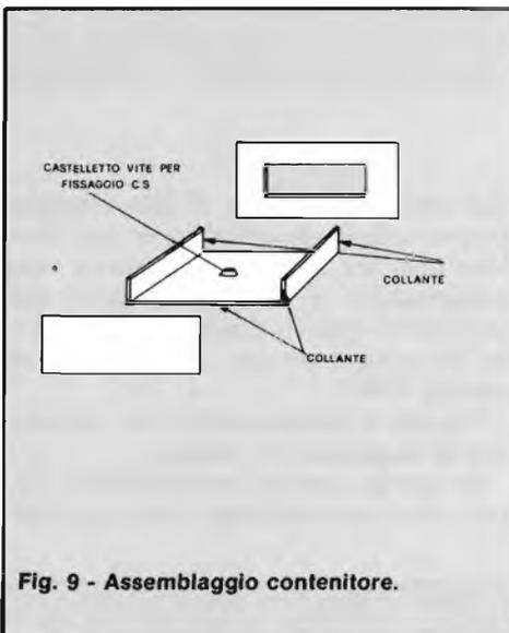
Fig. 9 - Assemblaggio contenitore.
