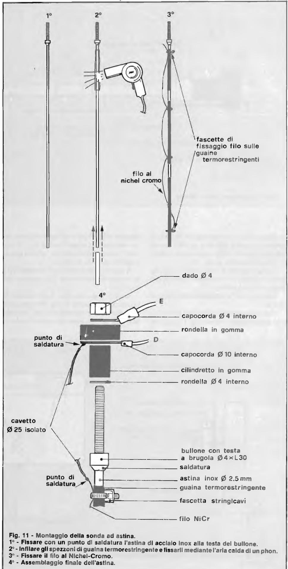
**Fig. 11 - Montaggio della sonda ad astina.**
