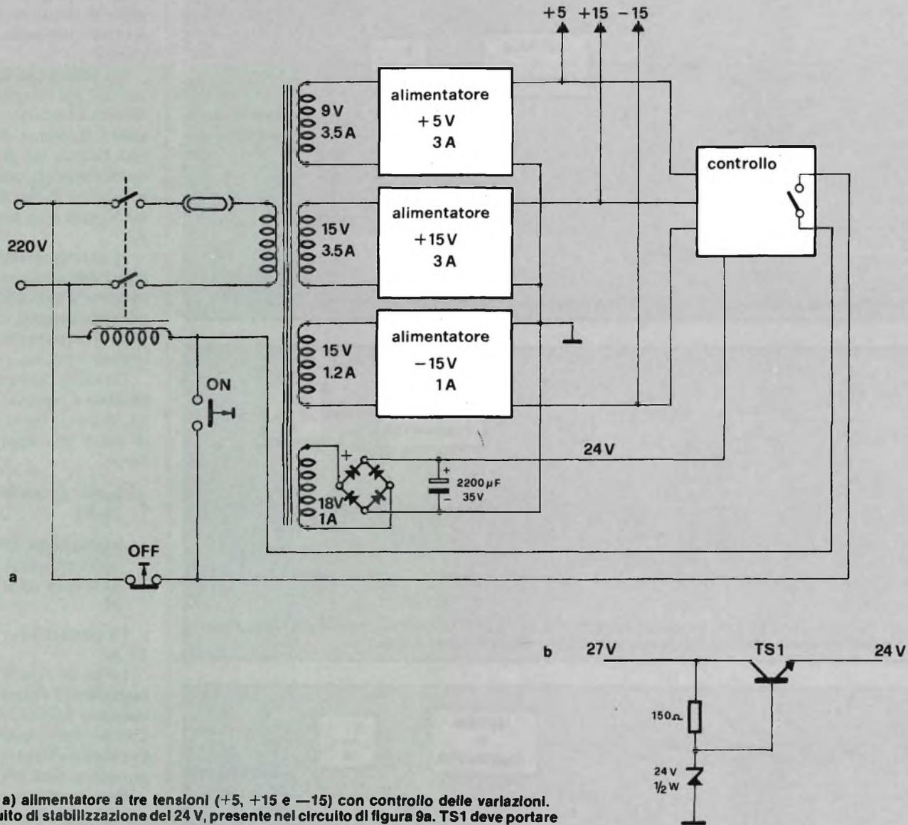
Fig. 9 - In a) alimentatore a tre tensioni (+5, +15 e -15) con controllo delle variazioni. In b) Circuito di stabilizzazione del 24 V, presente nel circuito di figura 9a. TS1 deve portare al massimo 1 A, e dissipare una potenza massima di 3 W.
