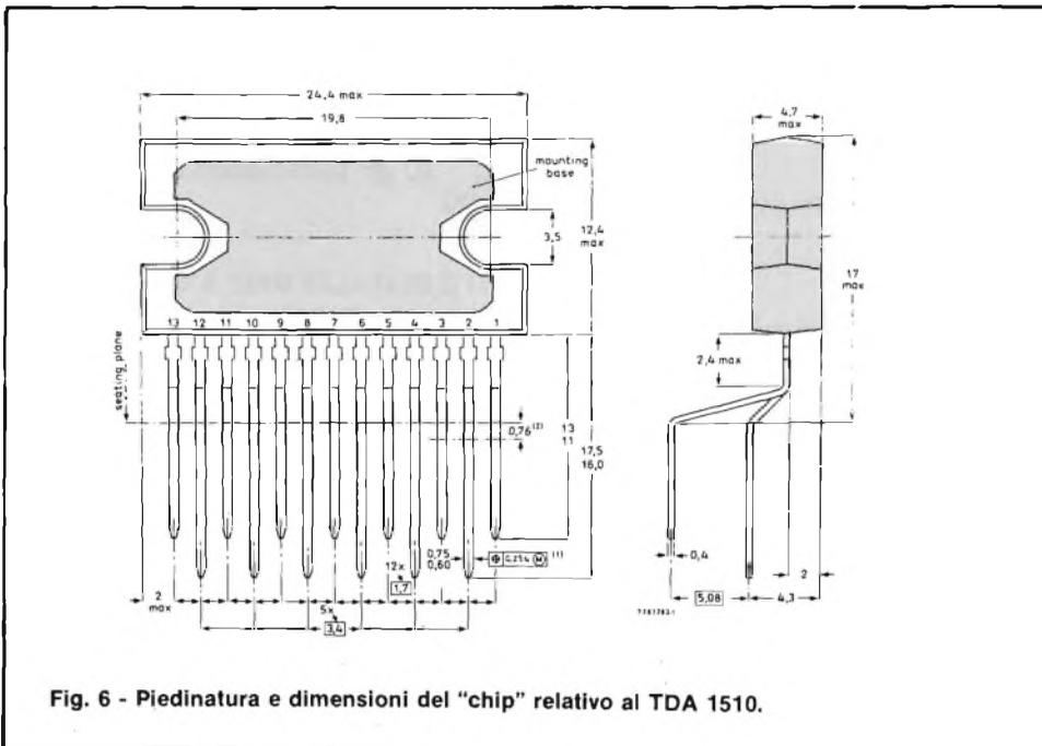
**Fig. 6 - Piedinatura e dimensioni del "chip" relativo al TDA 1510.**
