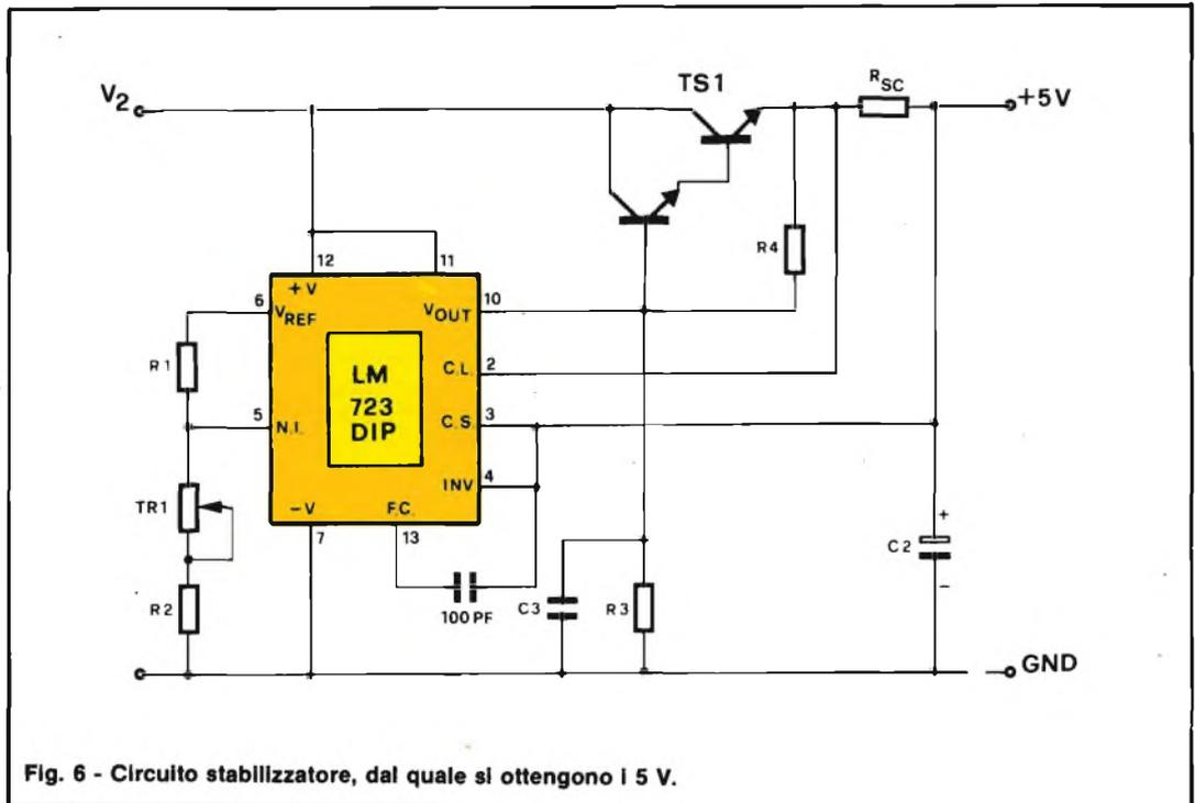
Fig. 6 - Circuito stabilizzatore, dal quale si ottengono i 5 V.
