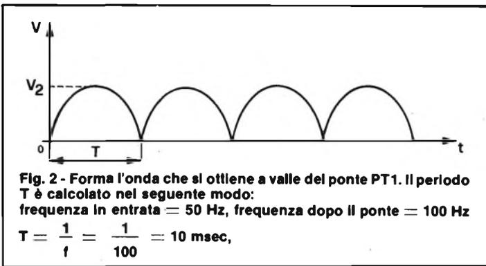
Fig. 2 - Forma l'onda che si ottiene a valle del ponte PT1. Il periodo T è calcolato nel seguente modo:
