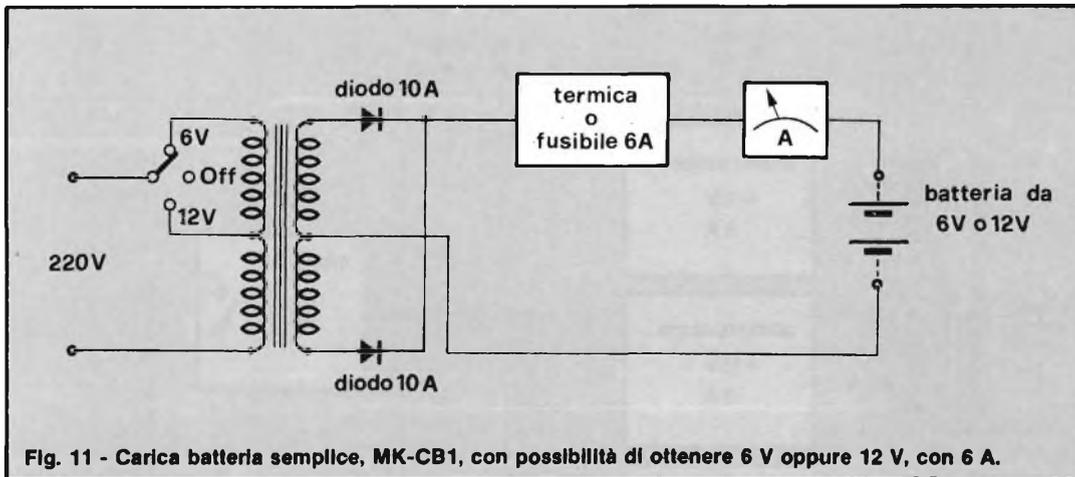
Fig. 11 - Carica batteria semplice, MK-CB1, con possibilità di ottenere 6 V oppure 12 V, con 6 A.
