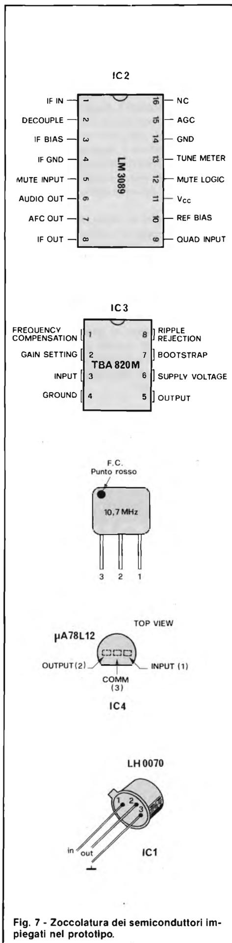
Fig. 7 - Zoccolatura dei semiconduttori impiegati nel prototipo.
