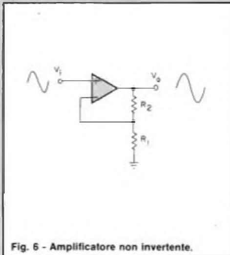
Fig. 6 - Amplificatore non invertente.
