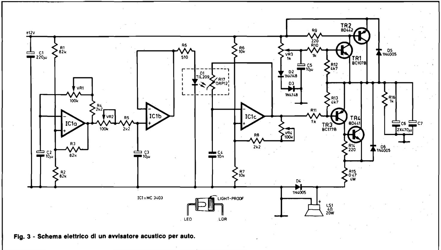
Fig. 3 - Schema elettrico di un avvisatore acustico per auto.
