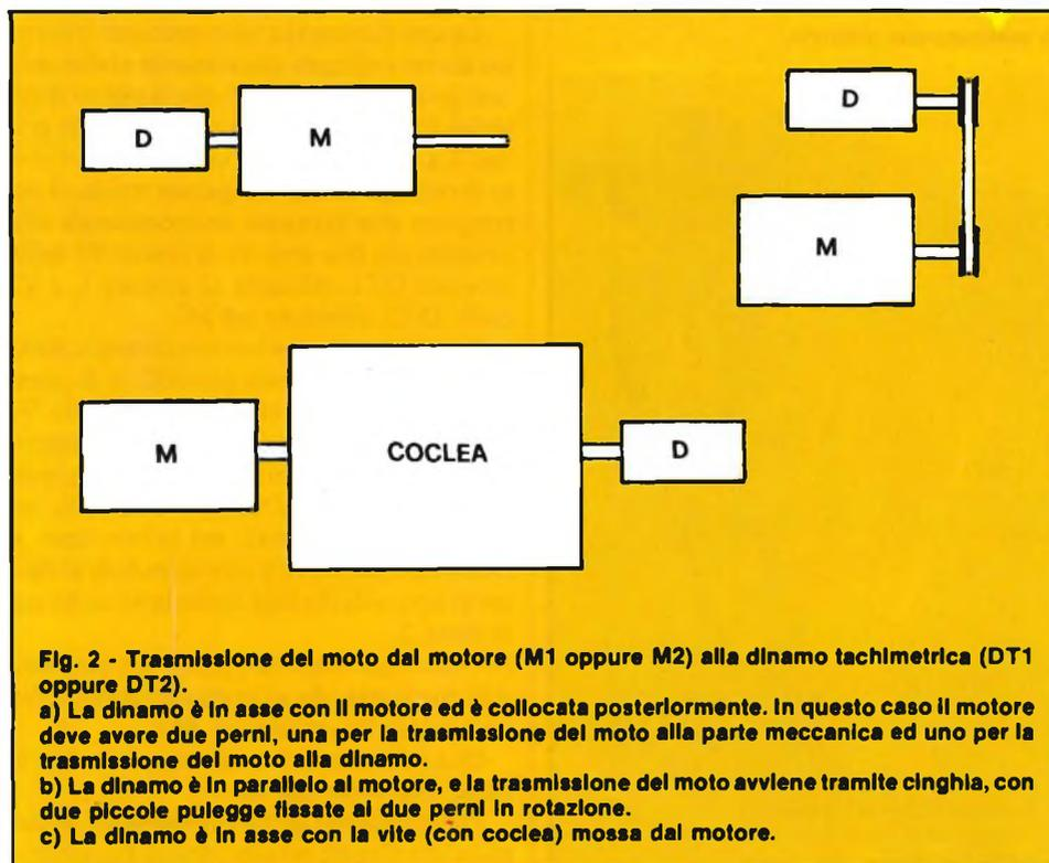
Fig. 2 - Trasmissione del moto dal motore (M1 oppure M2) alla dinamo tachimetrica (DT1 oppure DT2).
