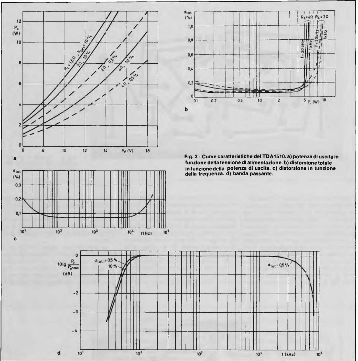
Fig. 3 - Curve caratteristiche del TDA1510. a) potenza di uscita in funzione della tensione di alimentazione. b) distorsione totale in funzione della potenza di uscita. c) distorsione in funzione della frequenza. d) banda passante.
