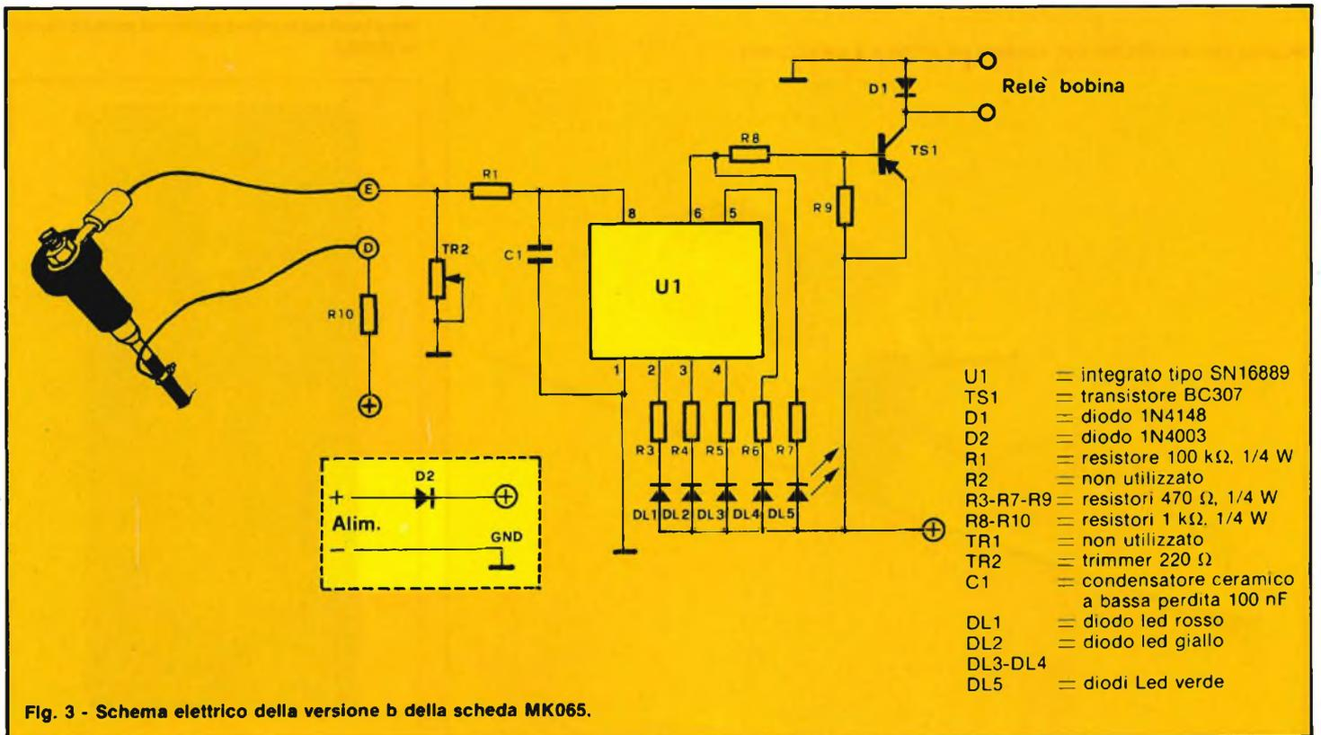
Fig. 3 - Schema elettrico della versione b della scheda MK065.
