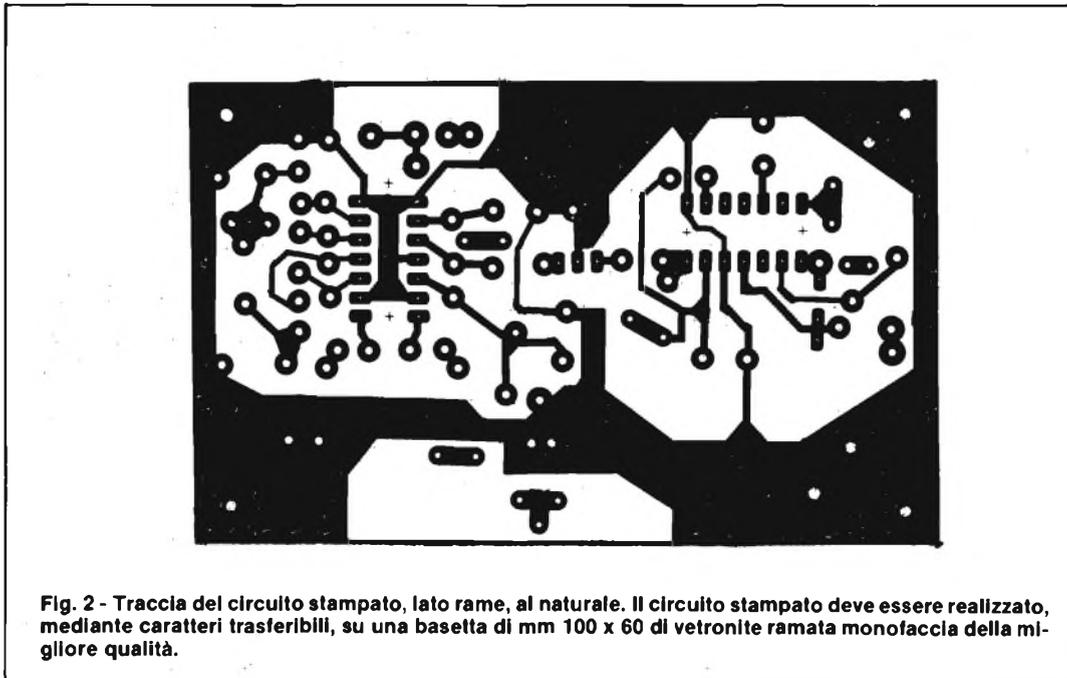
vuoi perchè le VHF, pur non essendo frequenza criticissime da trattare, richiedono già una buona dose di attenzione se si vogliono evitare problemi ed anche insuccessi, vuoi per ottenere una compattezza sufficiente a garantire la tascabilità del montaggio ultimato.
