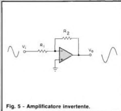
Fig. 5 - Amplificatore invertente.
