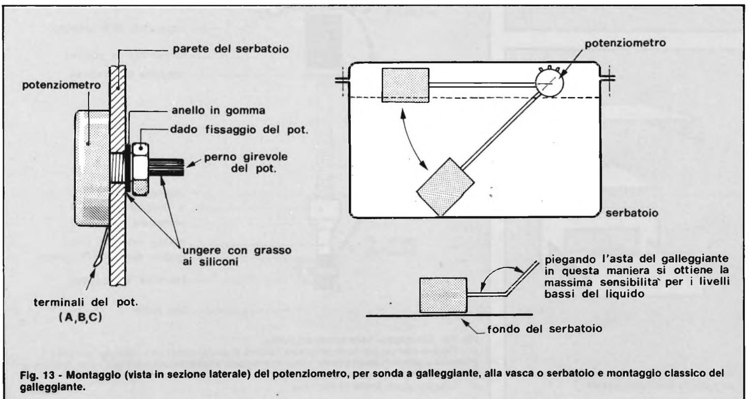
Fig. 13 - Montaggio (vista in sezione laterale) del potenziometro, per sonda a galleggiante, alla vasca o serbatoio e montaggio classico del galleggiante.
