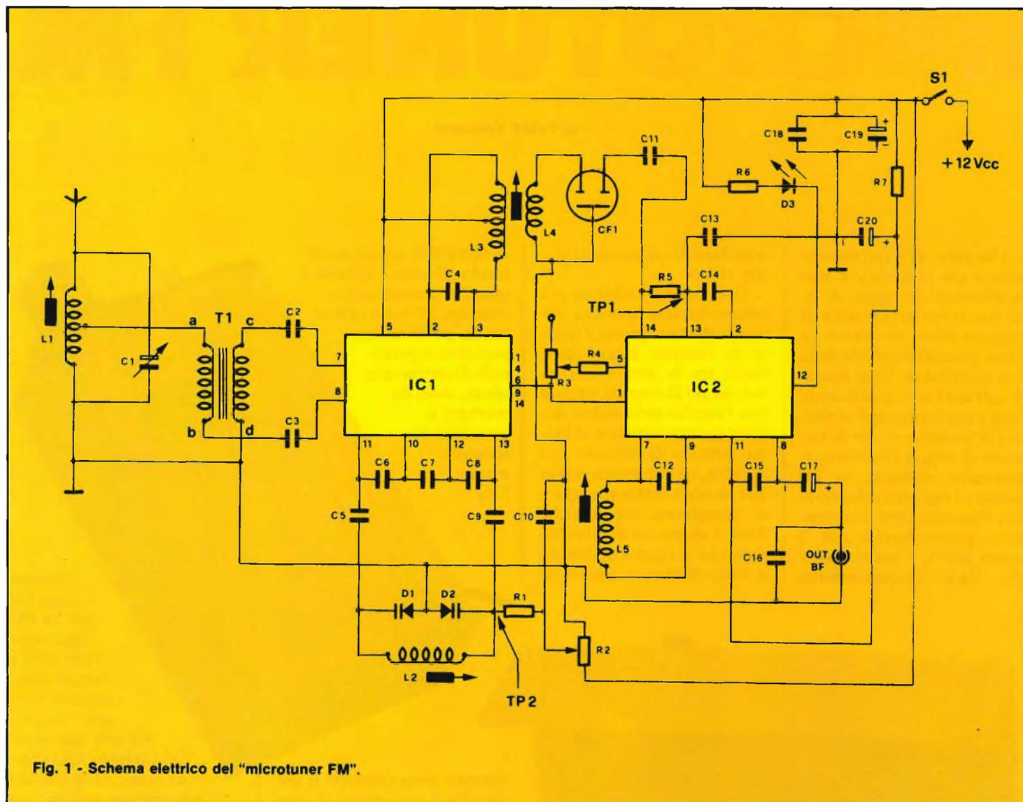
Fig. 1 - Schema elettrico del "microtuner FM".
