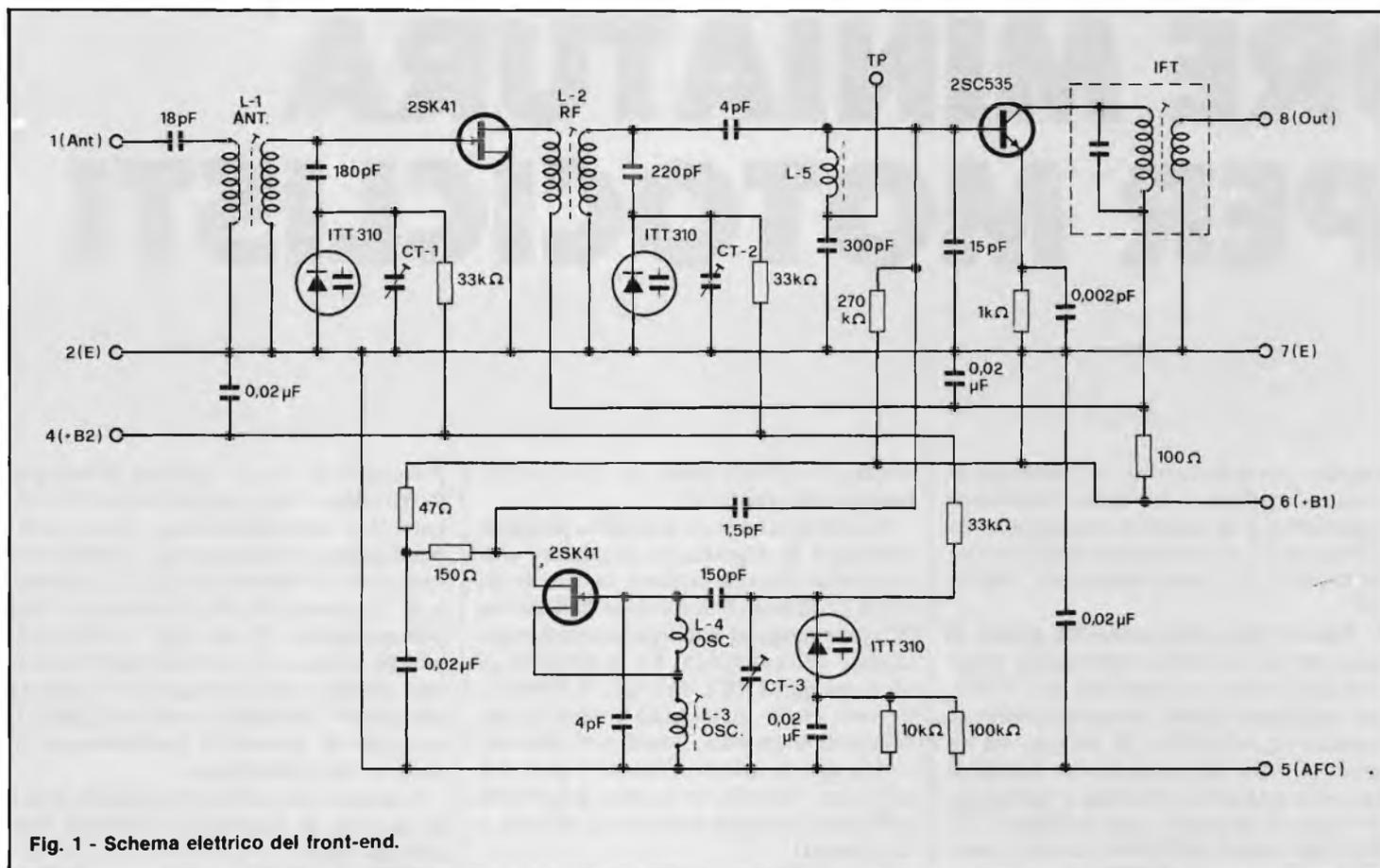
Fig. 1 - Schema elettrico del front-end.
