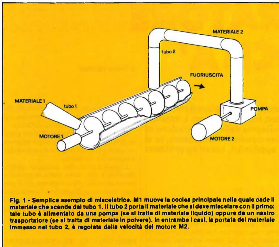
Fig. 1 - Semplice esempio di miscelatrice. M1 muove la coclea principale nella quale cade il materiale che scende dal tubo 1. Il tubo 2 porta il materiale che si deve miscelare con il primo; tale tubo è alimentato da una pompa (se si tratta di materiale liquido) oppure da un nastro trasportatore (se si tratta di materiale in polvere). In entrambi i casi, la portata del materiale immesso nel tubo 2, è regolata dalla velocità del motore M2.
