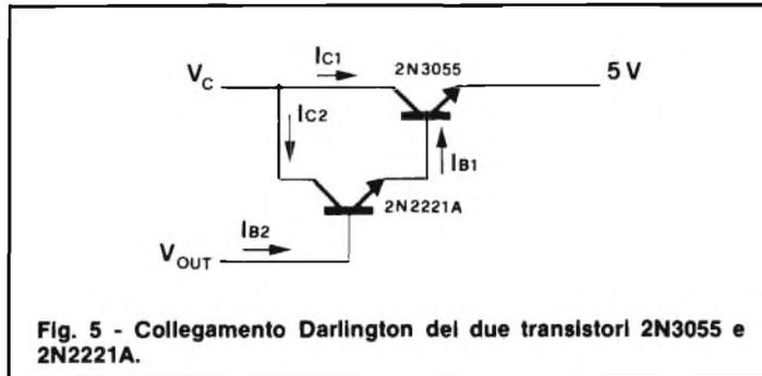
Fig. 5 - Collegamento Darlington dei due transistori 2N3055 e 2N2221A.
