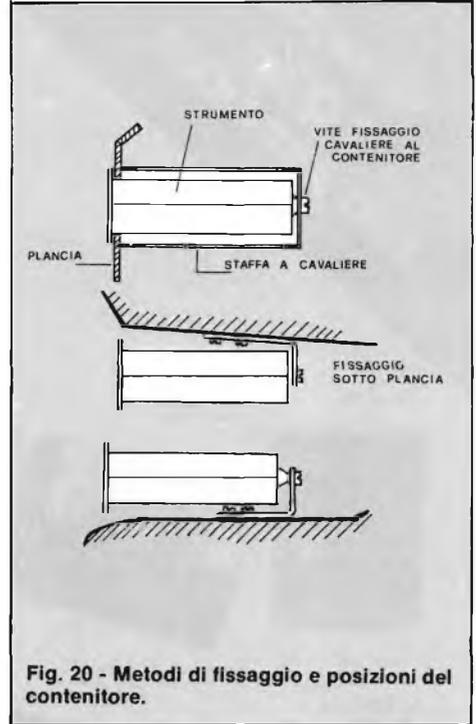
Fig. 20 - Metodi di fissaggio e posizioni del contenitore.
