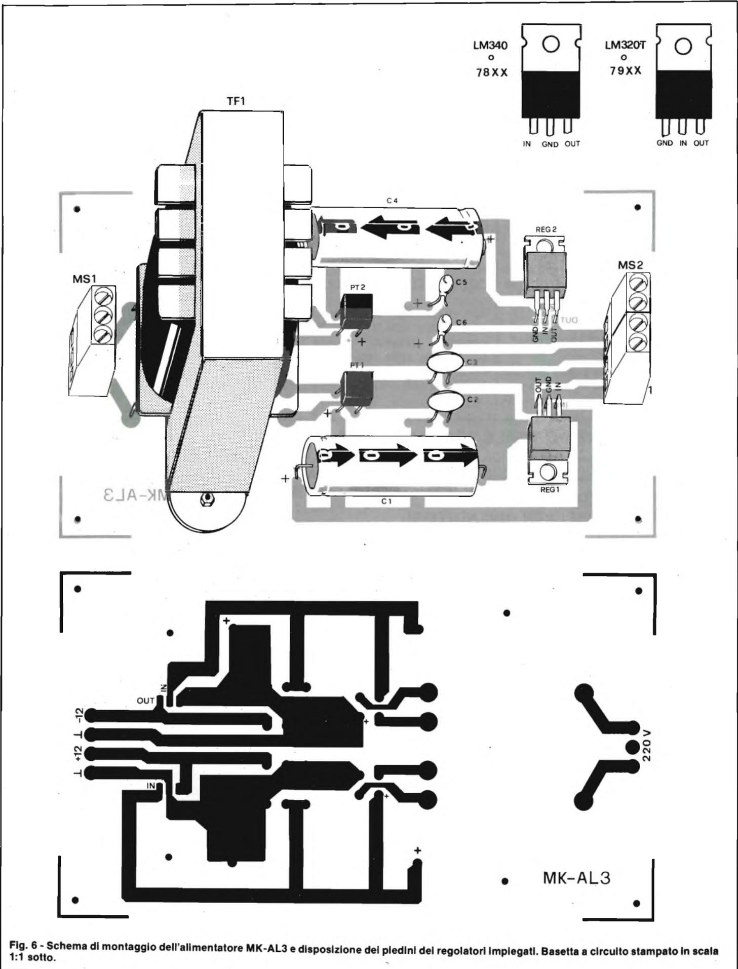
Fig. 6 - Schema di montaggio dell'alimentatore MK-AL3 e disposizione dei piedini dei regolatori impiegati. Basetta a circuito stampato in scala 1:1 sotto.
