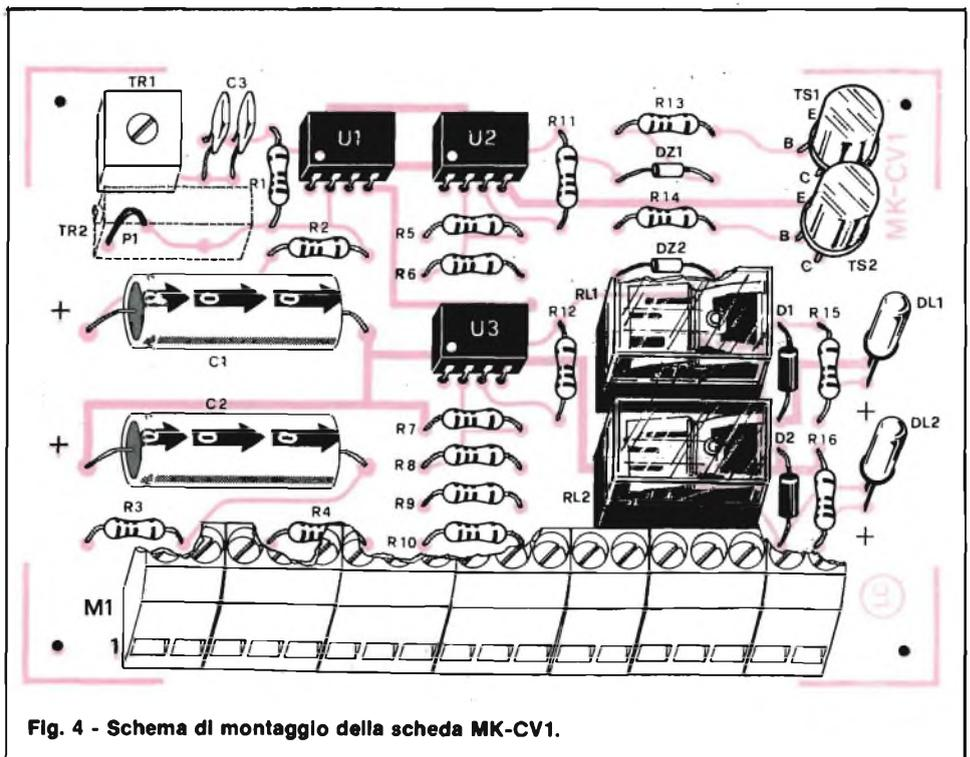
Fig. 4 - Schema di montaggio della scheda MK-CV1.
