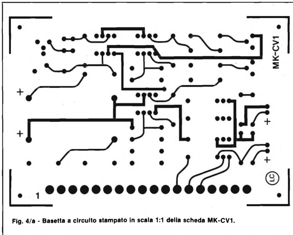
Fig. 4/a - Basetta a circuito stampato in scala 1:1 della scheda MK-CV1.
