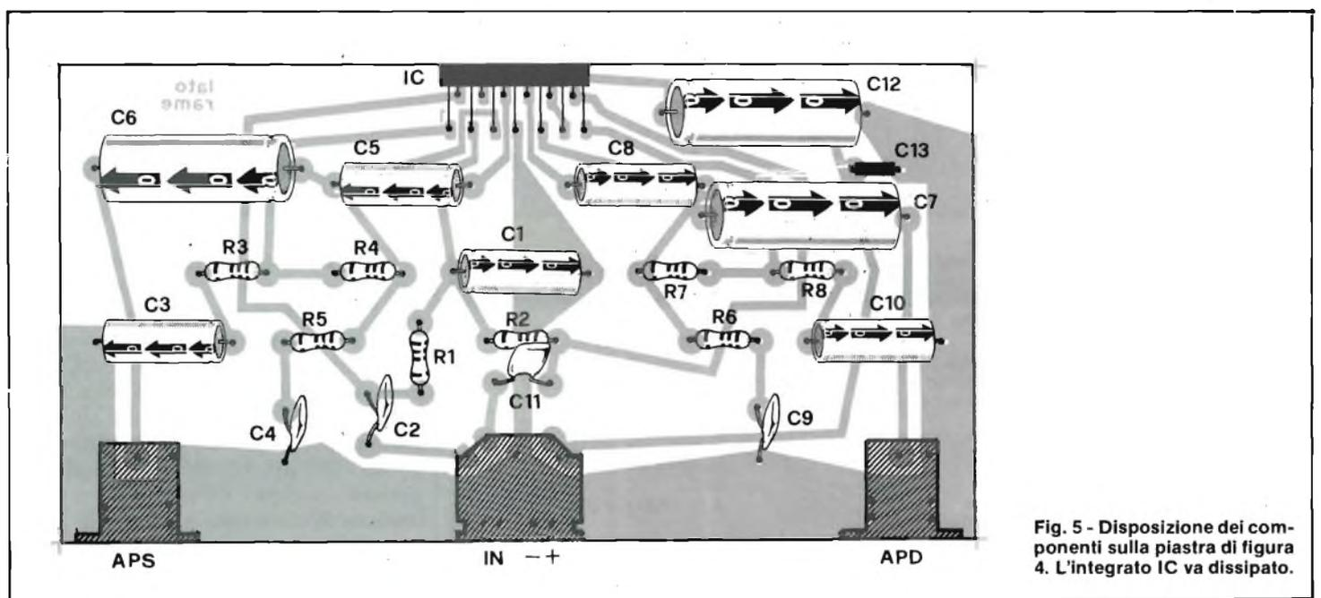
Fig. 5 - Disposizione dei componenti sulla piastra di figura 4. L'integrato IC va dissipato.
