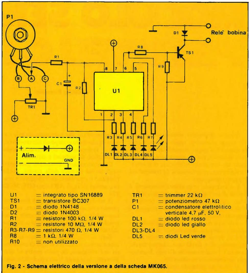
Fig. 2 - Schema elettrico della versione a della scheda MK065.
