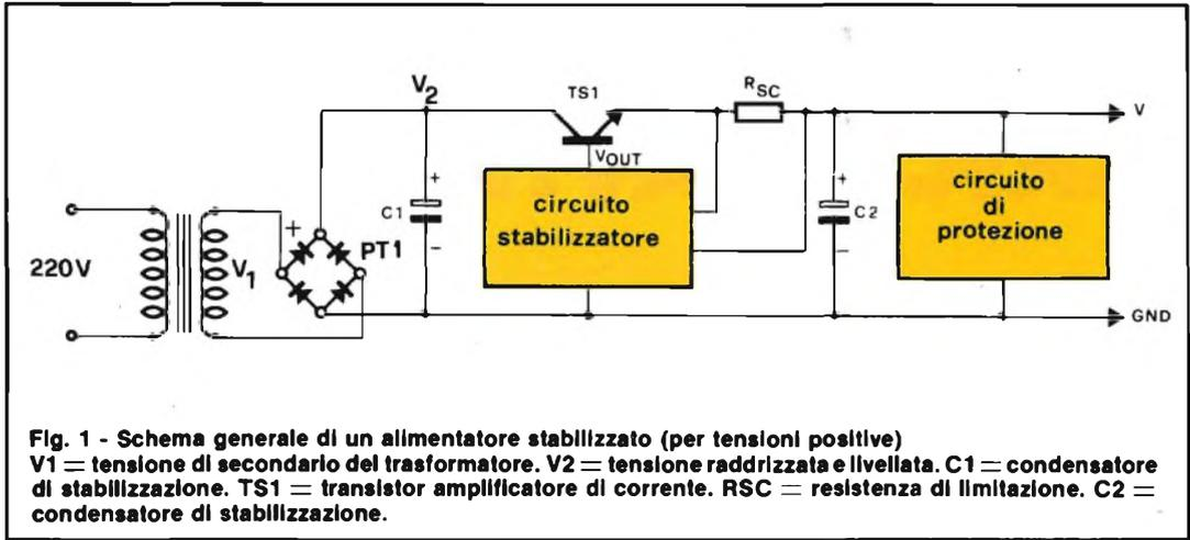
Fig. 1 - Schema generale di un alimentatore stabilizzato (per tensioni positive)
