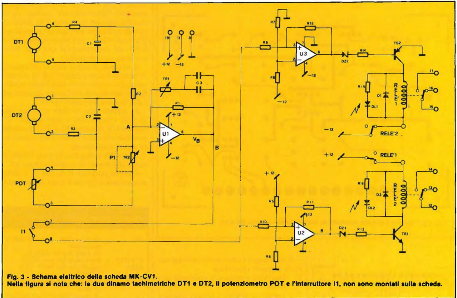
Fig. 3 - Schema elettrico della scheda MK-CV1. Nella figura si nota che: le due dinamo tachimetriche DT1 e DT2, il potenziometro POT e l'interruttore I1, non sono montati sulla scheda.
