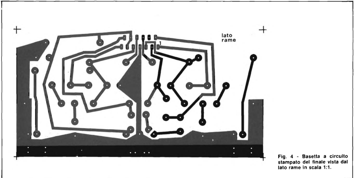
Fig. 4 - Basetta a circuito stampato del finale vista dal lato rame in scala 1:1.
