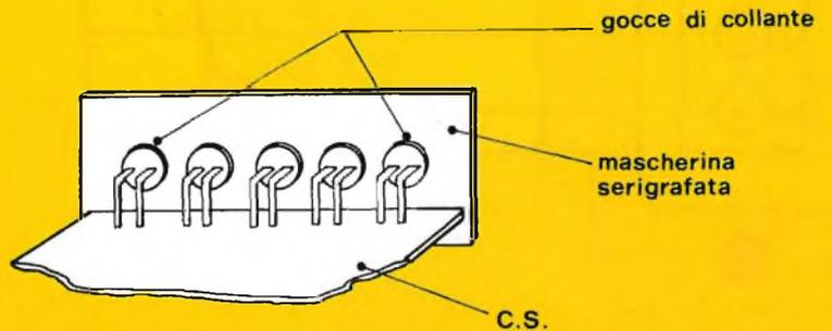
Fig. 8 - Fissaggio della mascherina ai led.
