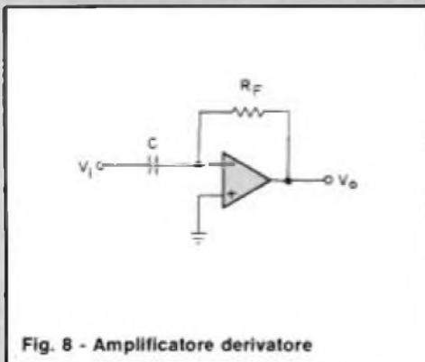
Fig. 8 - Amplificatore derivatore
