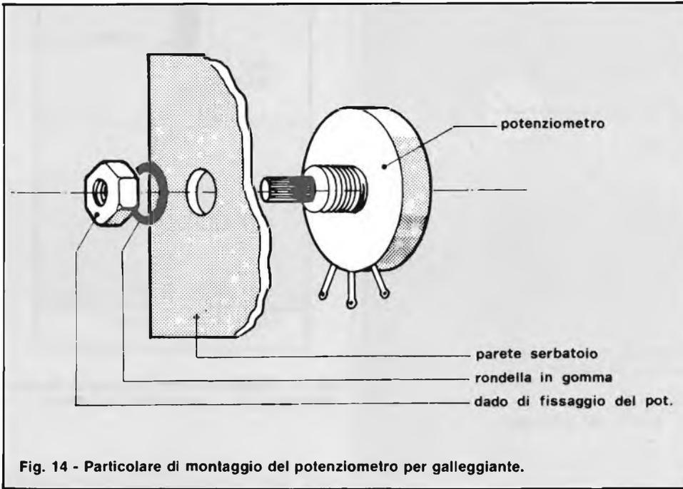
Fig. 14 - Particolare di montaggio del potenziometro per galleggiante.
