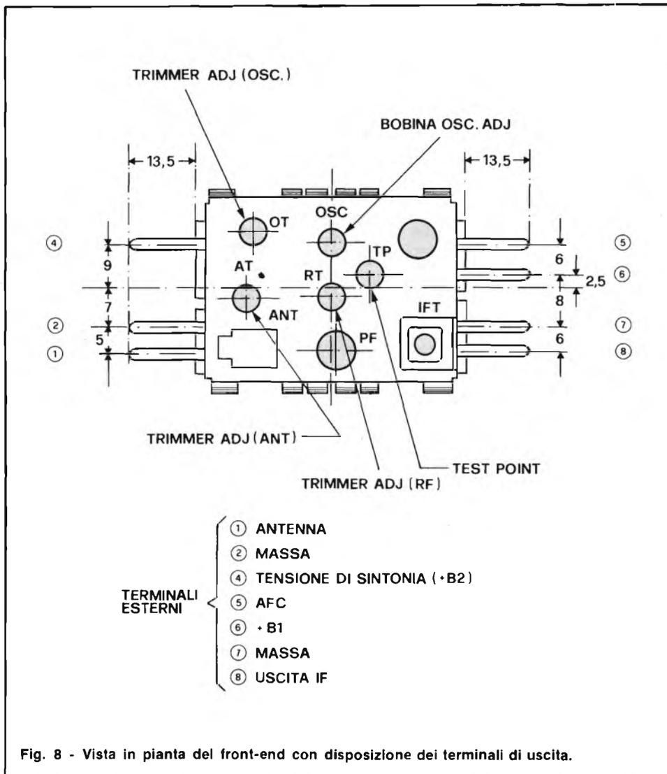
Fig. 8 - Vista in pianta del front-end con disposizione dei terminali di uscita.
