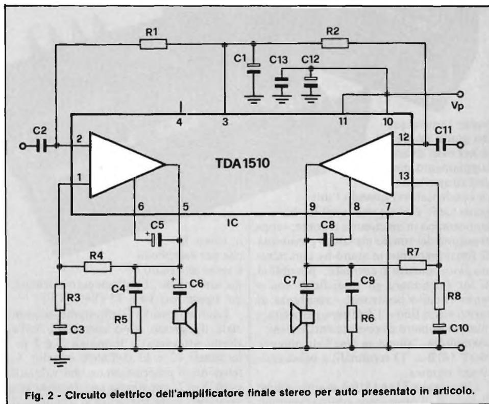
Fig. 2 - Circuito elettrico dell'amplificatore finale stereo per auto presentato in articolo.
