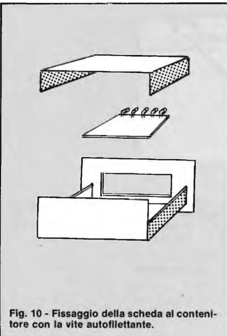
Fig. 10 - Fissaggio della scheda al contenitore con la vite autoflettante.
