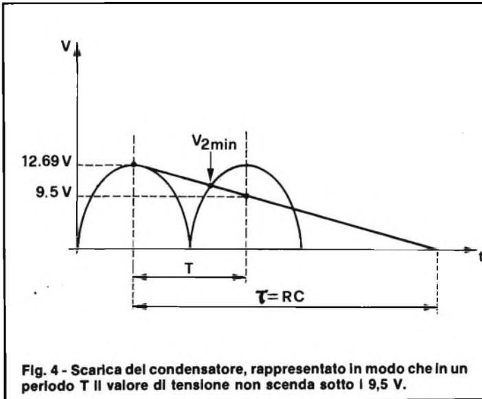
Fig. 4 - Scarica del condensatore, rappresentato in modo che in un periodo T il valore di tensione non scenda sotto i 9,5 V.
