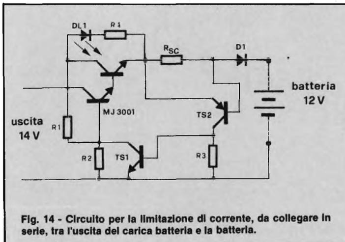
Fig. 14 - Circuito per la limitazione di corrente, da collegare in serie, tra l'uscita del carica batteria e la batteria.
