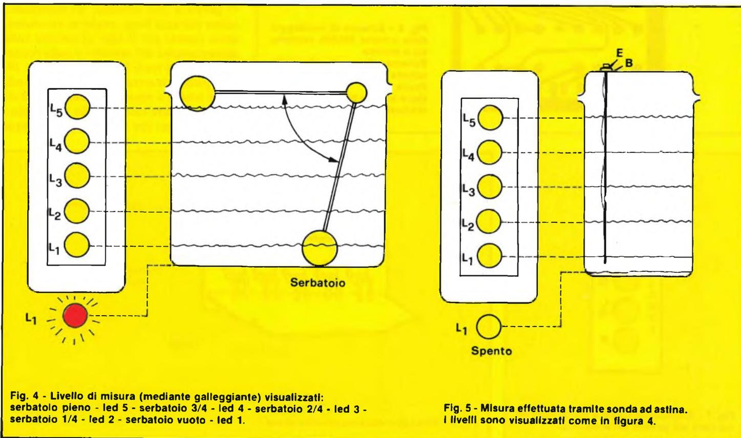
Fig. 4 - Livello di misura (mediante galleggiante) visualizzati: serbatoio pieno - led 5 - serbatoio 3/4 - led 4 - serbatoio 2/4 - led 3 - serbatoio 1/4 - led 2 - serbatoio vuoto - led 1.
