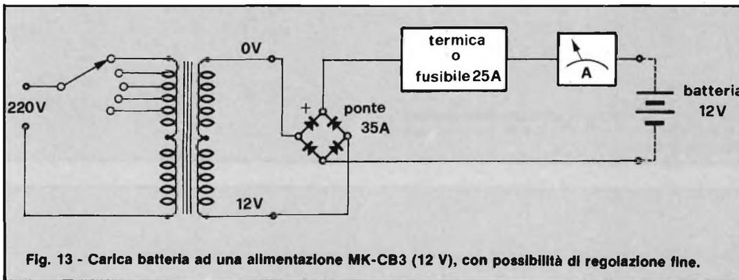
Fig. 13 - Carica batteria ad una alimentazione MK-CB3 (12 V), con possibilità di regolazione fine.
