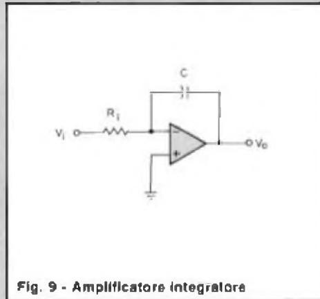
Fig. 9 - Amplificatore integratore
