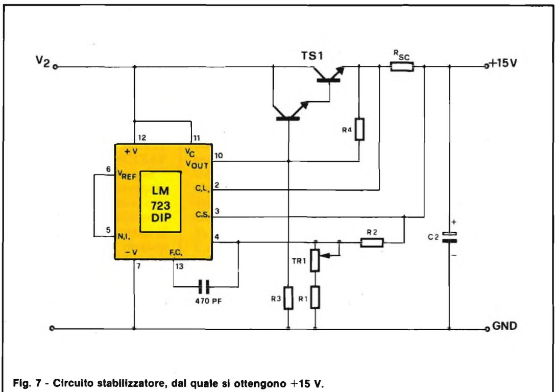
Fig. 7 - Circuito stabilizzatore, dal quale si ottengono +15 V.
