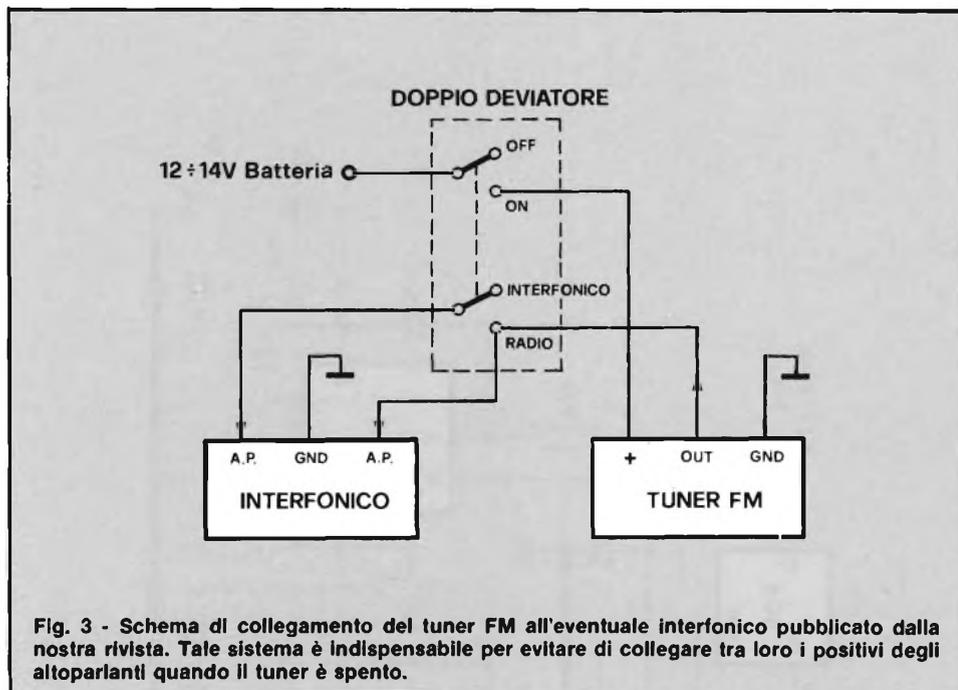
fa a preparare le basette "wafer", ma forse una ripetizione non è di troppo. In pratica, si procede al contrario del normale, se non si dispone di mezzi particolari per andare "a registro" con le ramature sovrapposte. Ciò vuol dir che prima si praticano i fori per le parti, ed in seguito si dispongono o le piste autoadesive e le piazzole, o le pellicole "master" facendo bene attenzione che coincidano con la foratura.
