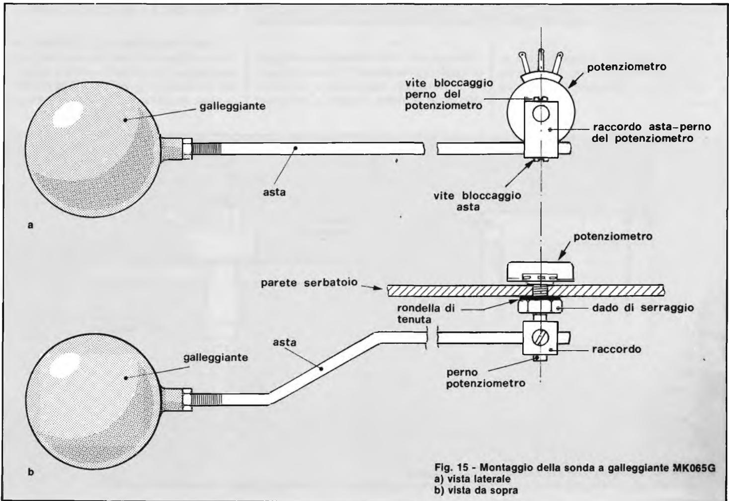
Fig. 15 - Montaggio della sonda a galleggiante MK065G
