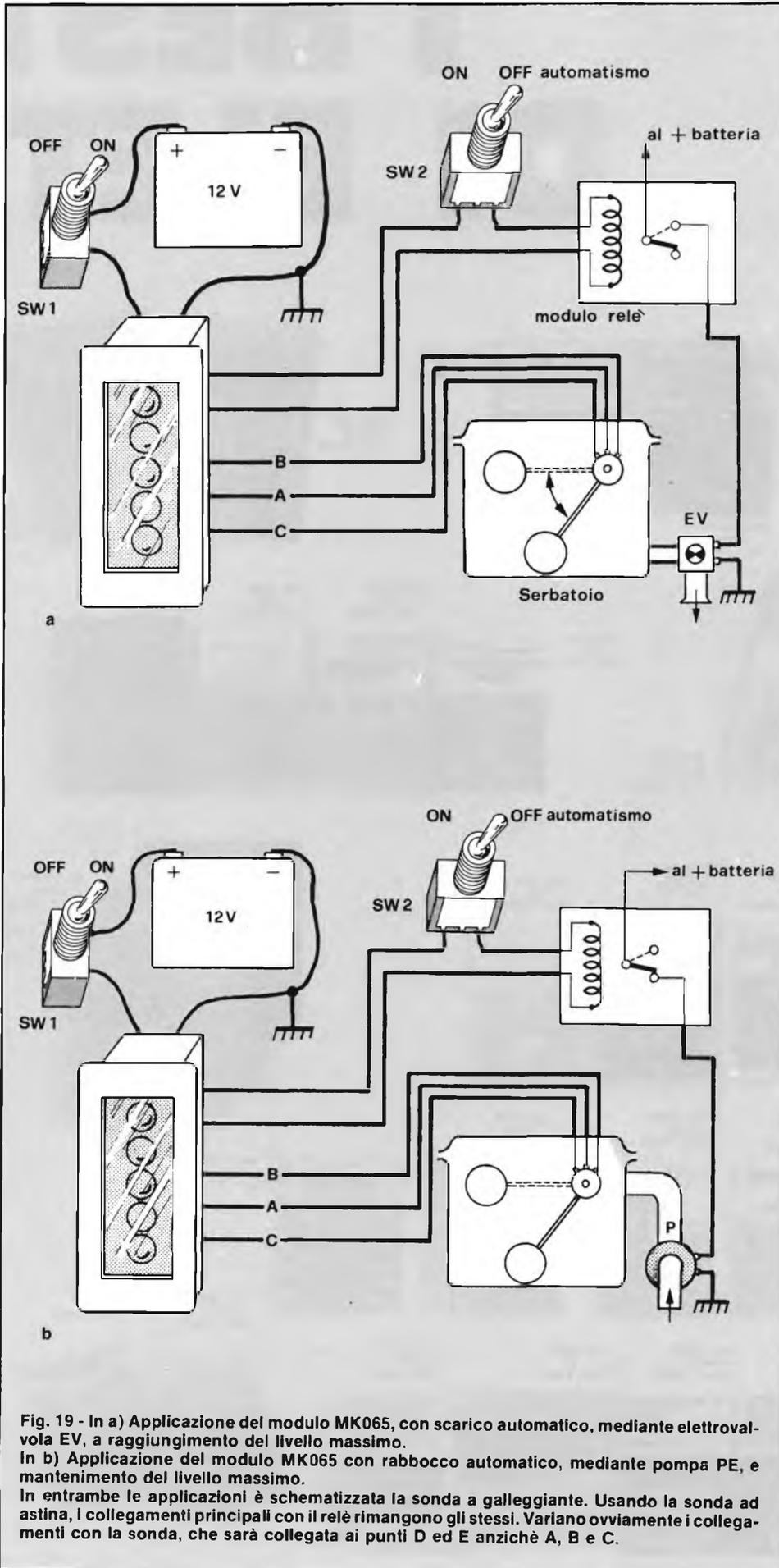
Fig. 19 - In a) Applicazione del modulo MK065, con scarico automatico, mediante elettrovalvola EV, a raggiungimento del livello massimo.
