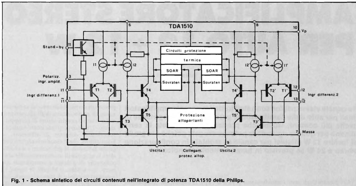
Fig. 1 - Schema sintetico del circuito contenuto nell'integrato di potenza TDA1510 della Philips.
