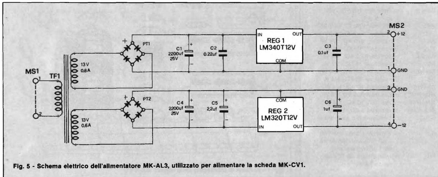
Fig. 5 - Schema elettrico dell'alimentatore MK-AL3, utilizzato per alimentare la scheda MK-CV1.
