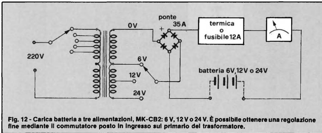
Fig. 12 - Carica batteria a tre alimentazioni, MK-CB2: 6 V, 12 V o 24 V. È possibile ottenere una regolazione fine mediante il commutatore posto in ingresso sul primario del trasformatore.
