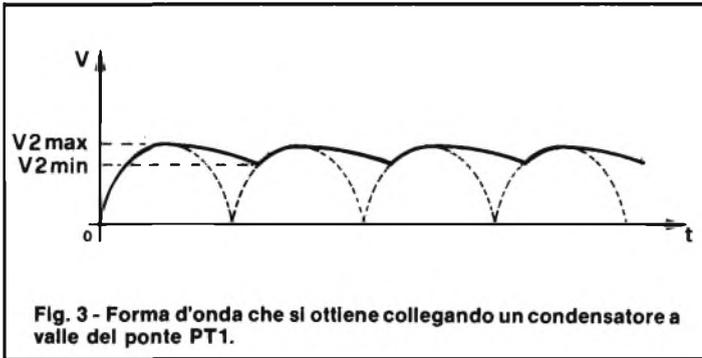
Fig. 3 - Forma d'onda che si ottiene collegando un condensatore a valle del ponte PT1.
