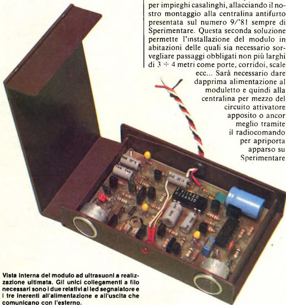
**Vista interna del modulo ad ultrasuoni a realizzazione ultimata. Gli unici collegamenti a filo necessari sono i due relativi al led segnalatore e i tre inerenti all'alimentazione e all'uscita che comunicano con l'esterno.**
