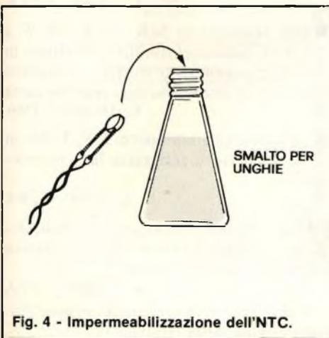
Fig. 4 - Impermeabilizzazione dell'NTC.
