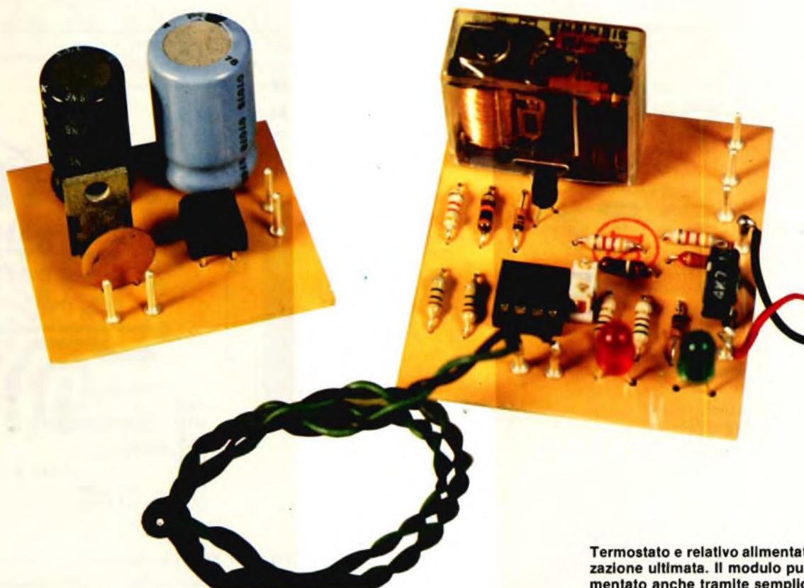
Termostato e relativo alimentatore a realizzazione ultimata. Il modulo può essere alimentato anche tramite semplice fila a 9V.
