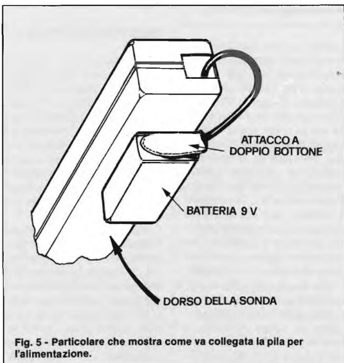
Fig. 5 - Particolare che mostra come va collegata la pila per l'alimentazione.
