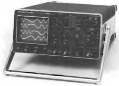
Il PM 3310 elimina la necessità di un convertitore analogico digitale di alto costo utilizzando un P<sup>2</sup>CCD (profiled Peristaltic Charge Coupled Device) per ridurre la frequenza del segnale. Il risultante segnale analogico di ingresso a più bassa frequenza può essere convertito nella forma digitale più economicamente.
