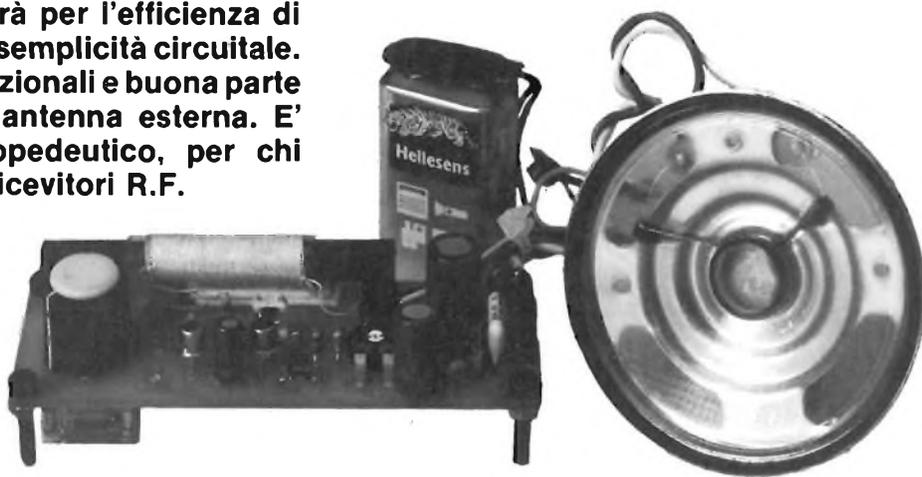
Foto 1 - Ricevitore MK 335-AM 500 ÷ 1600 kHz.
