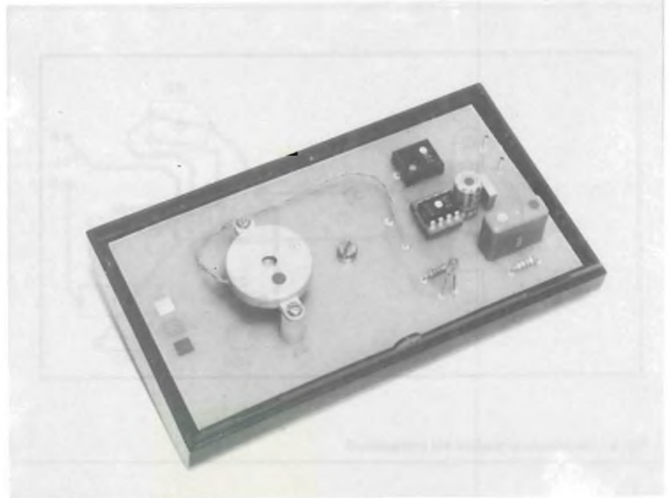
Vista interna del dispositivo (suoneria elettronica per telefono).
