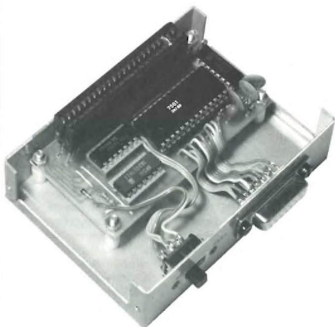
Progetto a realizzazione ultimata. Si notino le colonnine di fissaggio della stampato e la bandella di connessione al connettore CANNON.
