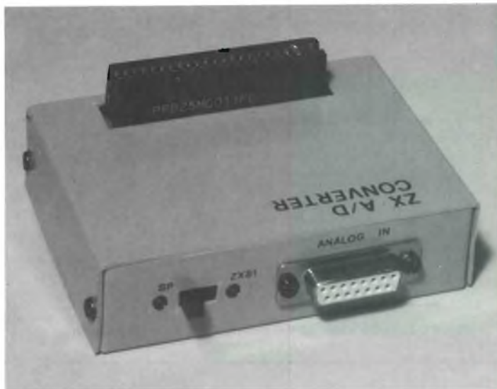
Il convertitore A/D è racchiuso in un contenitore metallico dal quale fuoriesce il connettore di collegamento al computer.
