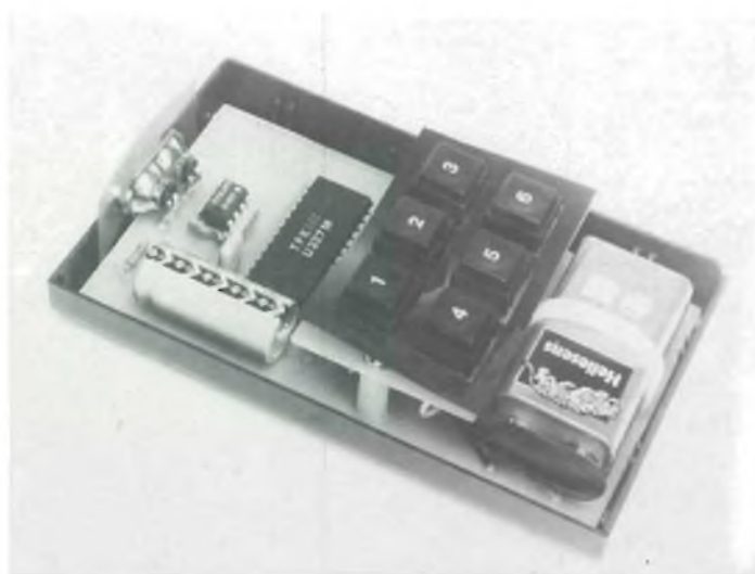
Trasmettitore a realizzazione ultimata. Per ragioni di contenitore la tastiera è stata sollevata con dei dissipatori.
