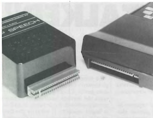
Il modulo sintetizzatore di voce va collegato al bus dello ZX81 tramite il connettore classico.
