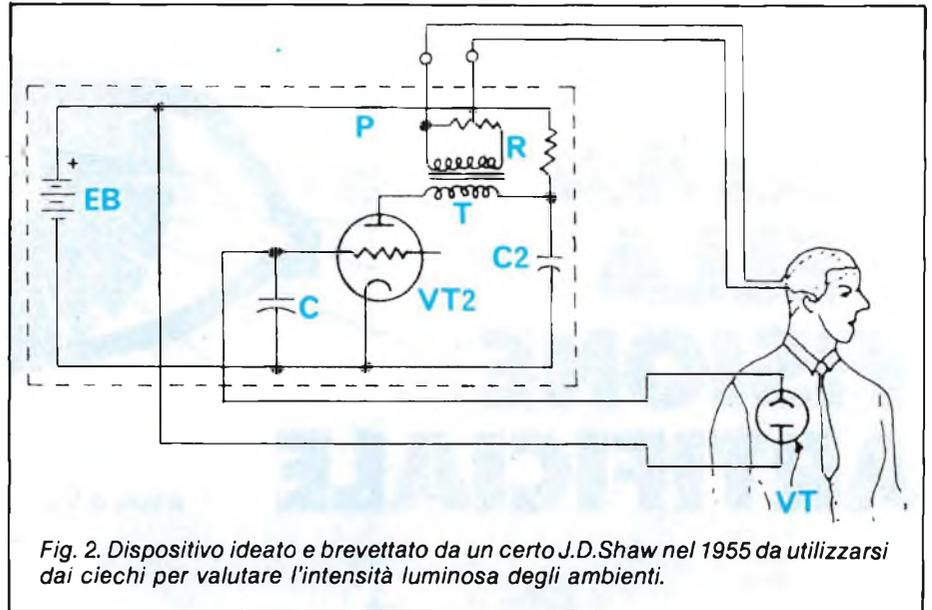
Fig. 2. Dispositivo ideato e brevettato da un certo J.D. Shaw nel 1955 da utilizzarsi dai ciechi per valutare l'intensità luminosa degli ambienti.
