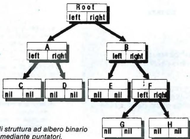
*Esempio di struttura ad albero binario realizzata mediante puntatori.*
