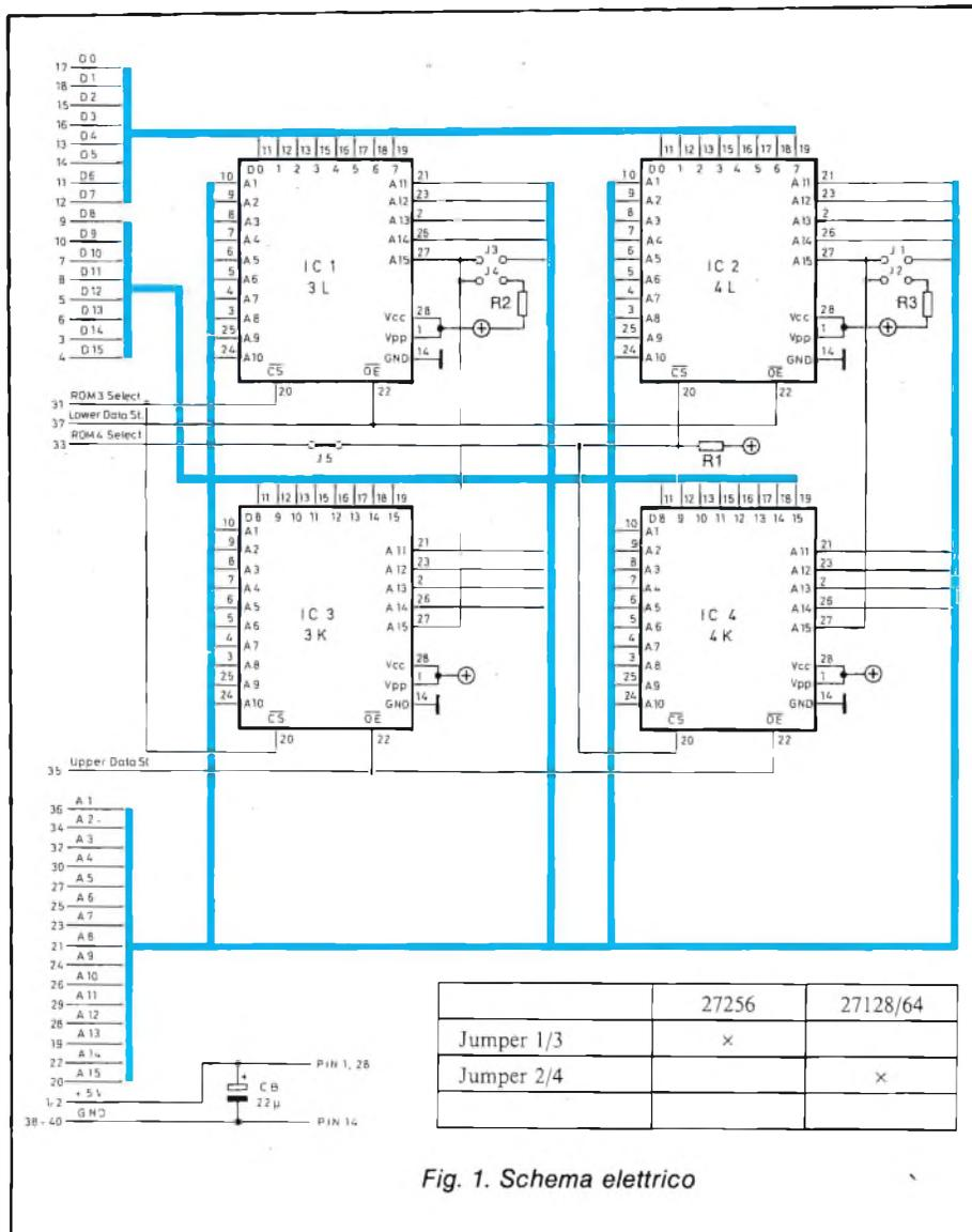
Fig. 1. Schema elettrico
