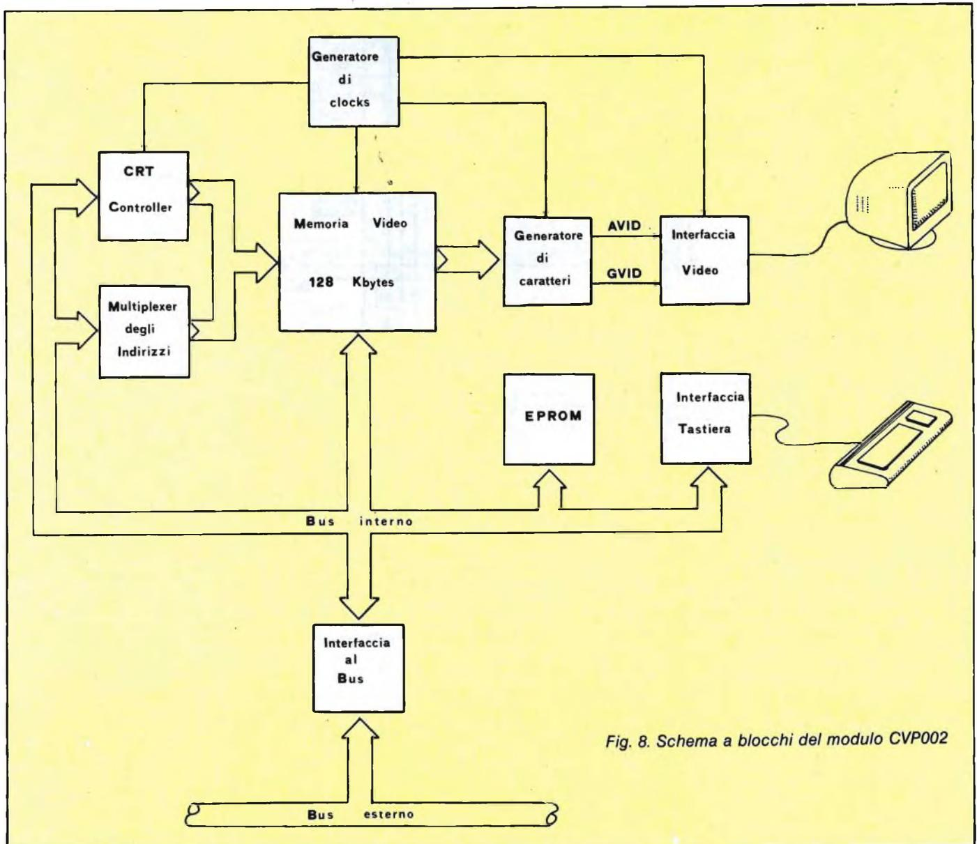
Fig. 8. Schema a blocchi del modulo CVP002
