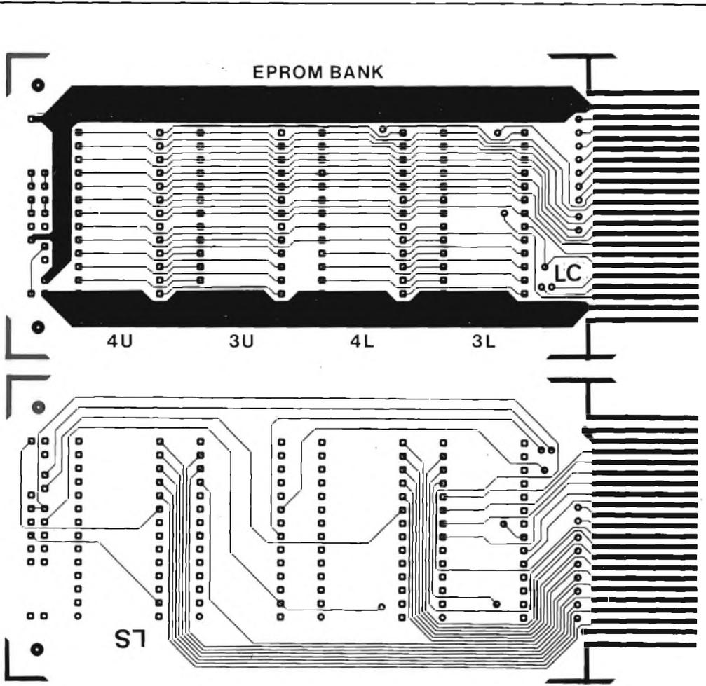
Fig. 3. Circuito stampato lato componenti e lato saldature
