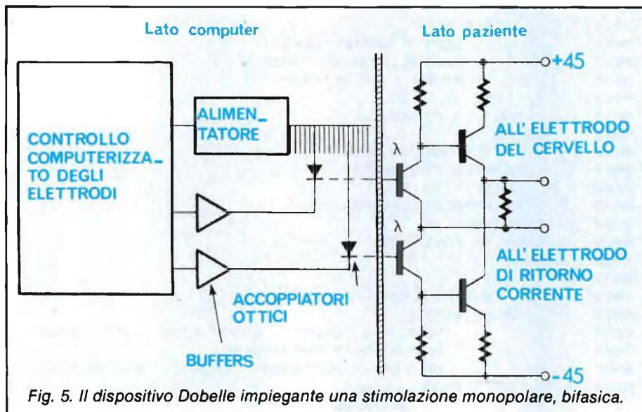
**Fig. 5. Il dispositivo Dobelle impiegante una stimolazione monopolare, bifasica.**
