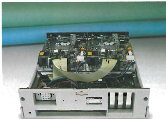
*Vista posteriore dell'unità centrale M19. Si notino gli slot per le espansioni e l'originale connettore per il collegamento al monitor posto sulla destra.*
