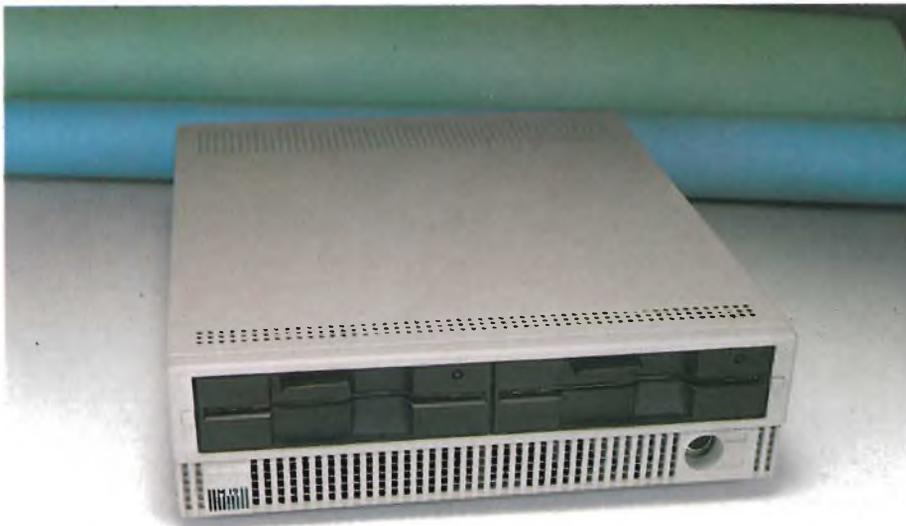
*Frontale dell'unità centrale M19. Si noti il connettore sulla sinistra per il collegamento alla tastiera e nella parte superiore i due floppy disk drive da 360 K.*
