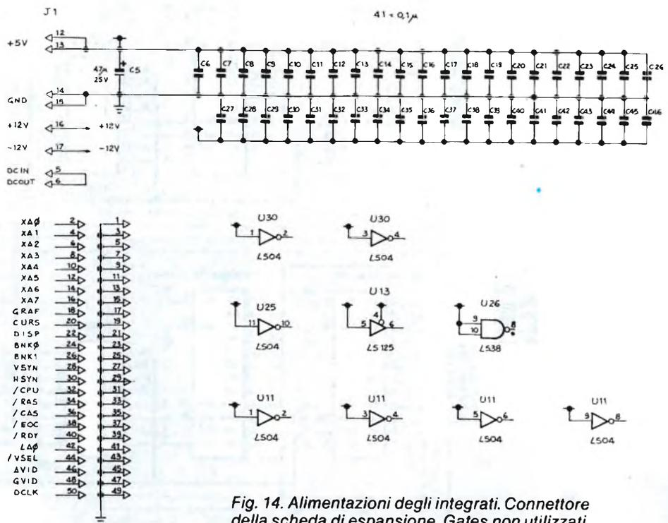
Fig. 14. Alimentazioni degli integrati. Connettore della scheda di espansione. Gates non utilizzati.
