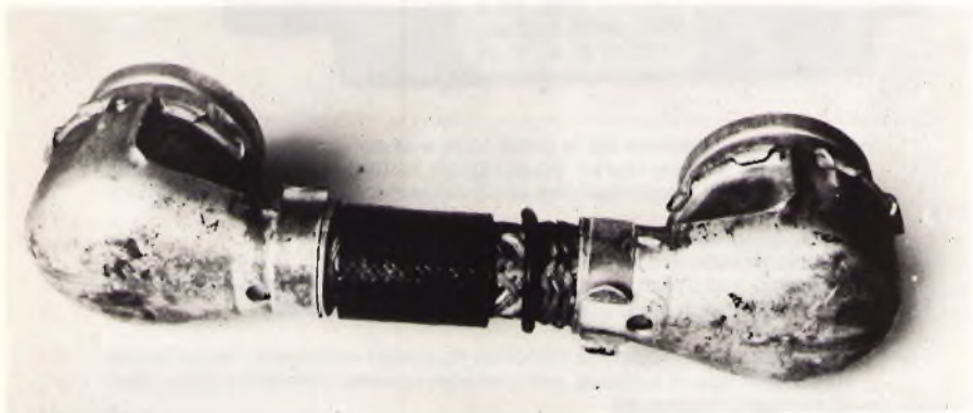
Il cosiddetto "osso di morto" che collega l'unità base all'alimentatore.
