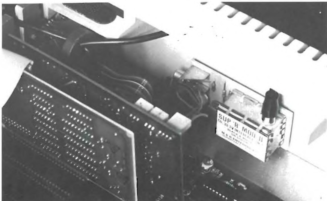
figura 5 Una possibile collocazione di un modulatore commerciale.
