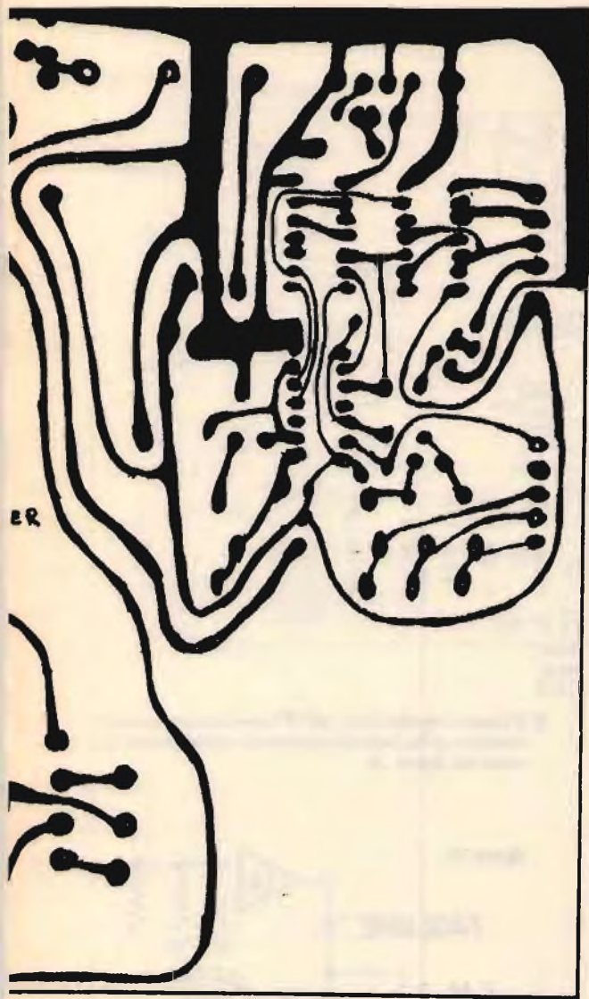
figura 7 Stampato lato rame (scala 1:1).
