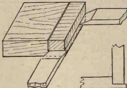
Fig. 4.—Removing Waste.
