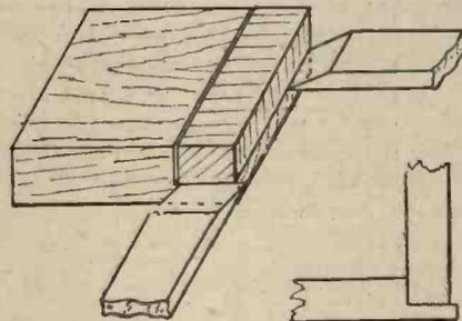
Fig. 4.—Removing Waste.
