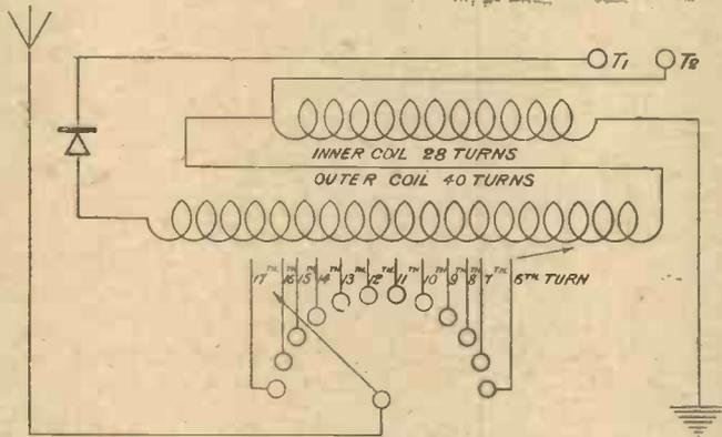
Fig. 4.—Circuit Diagram.
