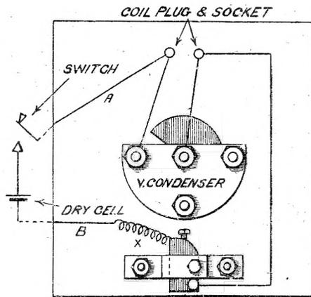
Fig. 4.—Wiring Diagram.
