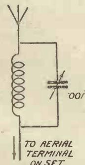
Fig. 8.—Wave-trap Circuit.
