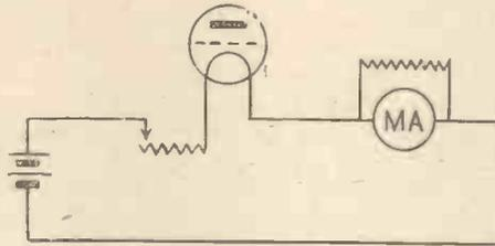
Fig. 7.—The Ammeter Shunt.
