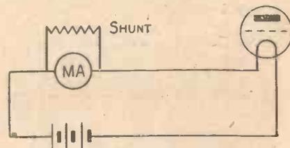
Fig. 2.—The Ammeter Shunt.
