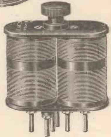
**BINOCULAR ABSORPTION WAVE-TRAP**
