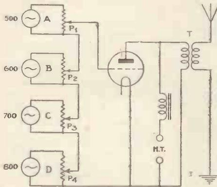
Fig. 1.—Semi-television transmitter
