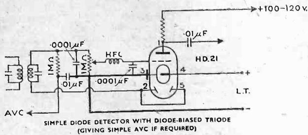
SIMPLE DIODE DETECTOR WITH DIODE-BIASED TRIODE (GIVING SIMPLE AVC IF REQUIRED)
