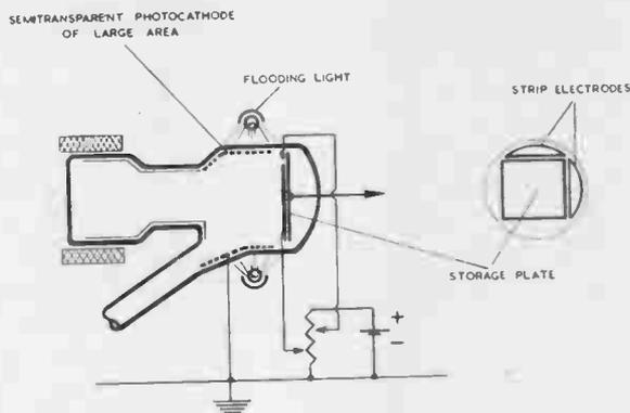
Fig. 7.—Diagram of the P.E.S. Photicon.
