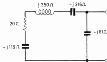
Fig. 9. 136 MHz output circuit.
