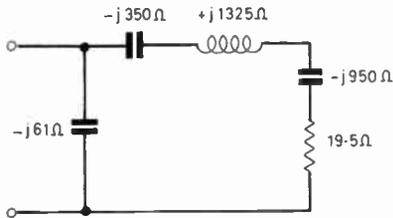
Fig. 8. 17 MHz input circuit.
