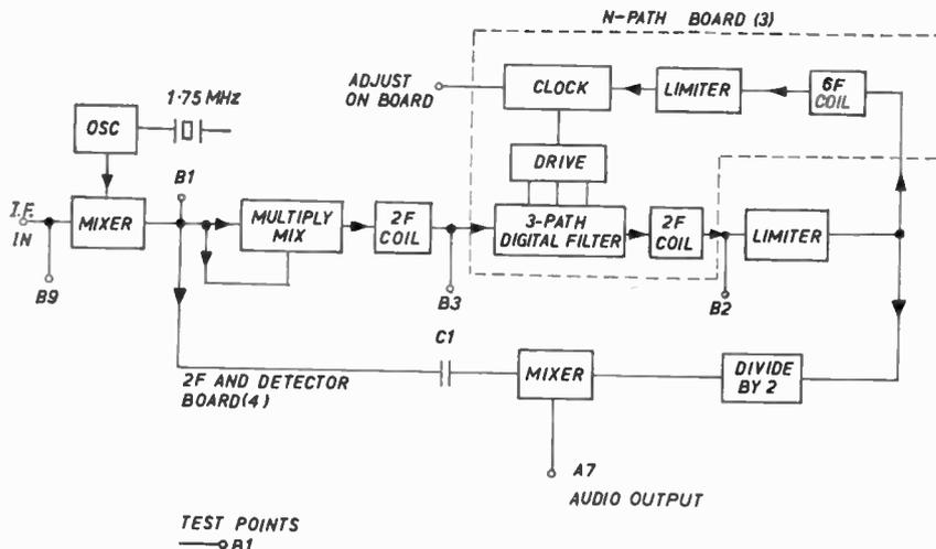
Fig. 6. D.s.b. detector arrangement.
