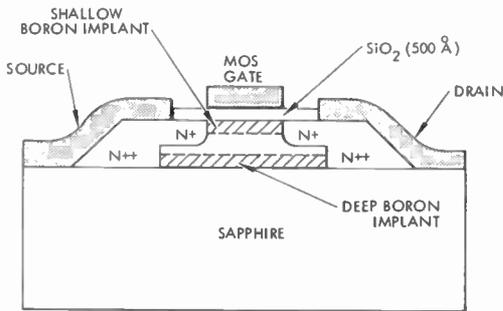
**Fig. 1. Silicon-on-sapphire m.o.s.f.e.t.**
