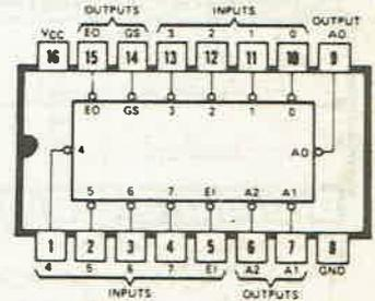
74351 DUAL EIGHT-LINE TO SINGLE-LINE DATA SELECTORS/MULTIPLEXERS, TRI-STATE OUTPUTS
