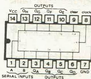
**74165 PARALLEL LOAD EIGHT-BIT SHIFT REGISTER WITH COMPLEMENTARY OUTPUTS**
