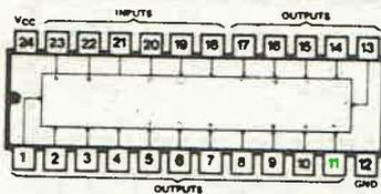
**74155 DUAL TWO-TO-FOUR-LINE DECODER/DUAL ONE-TO-FOUR-LINE DEMULTIPLEXER/THREE-TO-EIGHT-LINE DECODER/ONE-TO-EIGHT-LINE DEMULTIPLEXER**
