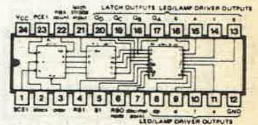
**74144** COUNTER/LATCH/DECODER/DRIVER (15 V 25 mA OPEN COLLECTOR OUTPUTS)
