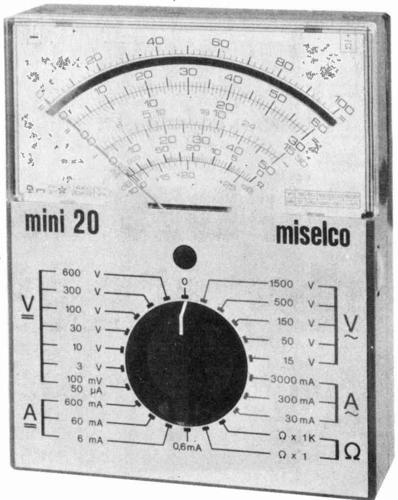
Sensitivity 20k $\Omega$ /V d.c. 4k $\Omega$ /V a.c.
