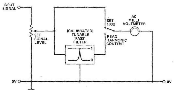
Fig. 2 Harmonic analyser arrangement.
