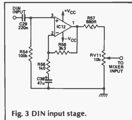
Fig. 3 DIN input stage.
