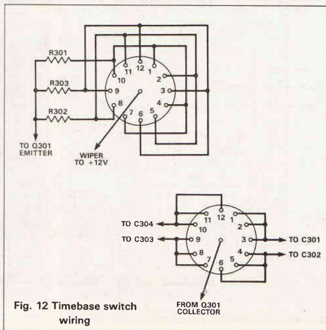
Fig. 12 Timebase switch wiring
