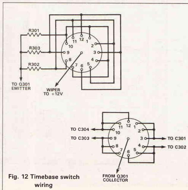
Fig. 12 Timebase switch wiring
