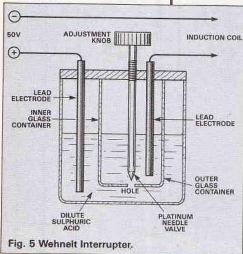
Fig. 5 Wehnelt Interrupter.
