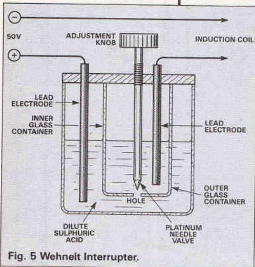
Fig. 5 Wehnelt Interrupter.
