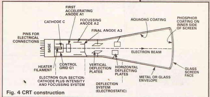
Fig. 4 CRT construction
