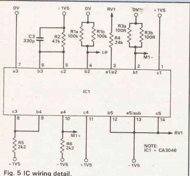
Fig. 5 IC wiring detail.
