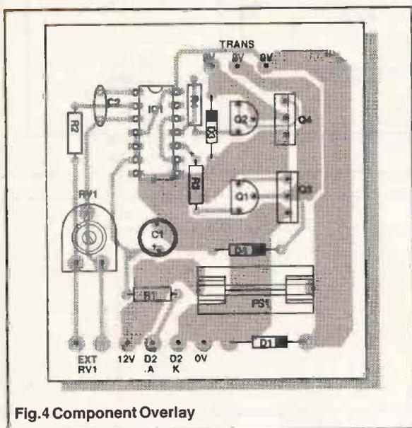
Fig. 4 Component Overlay
