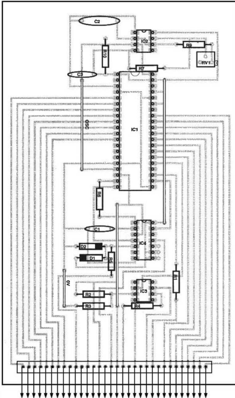
Fig. 15. Component overlay.
