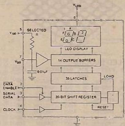
FIGURE 1—Block Diagram
