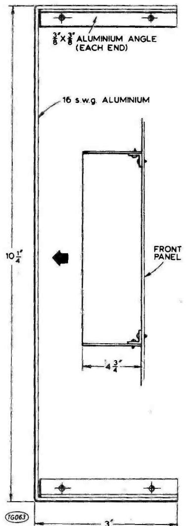
Fig. 4a) Details of the chassis.
