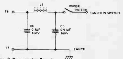
Fig. 2. Suppression Circuit
