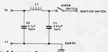
Fig. 2. Suppression Circuit
