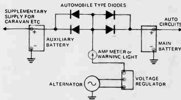
AUXILIARY BATTERY ADAPTER FOR NEG. EARTH AUTO. SYSTEM
