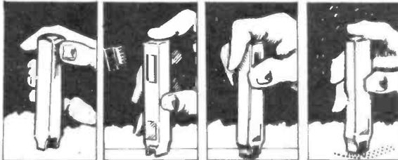
STRAIGHTEN PINS    RELEASE    PICK UP    INSERT
